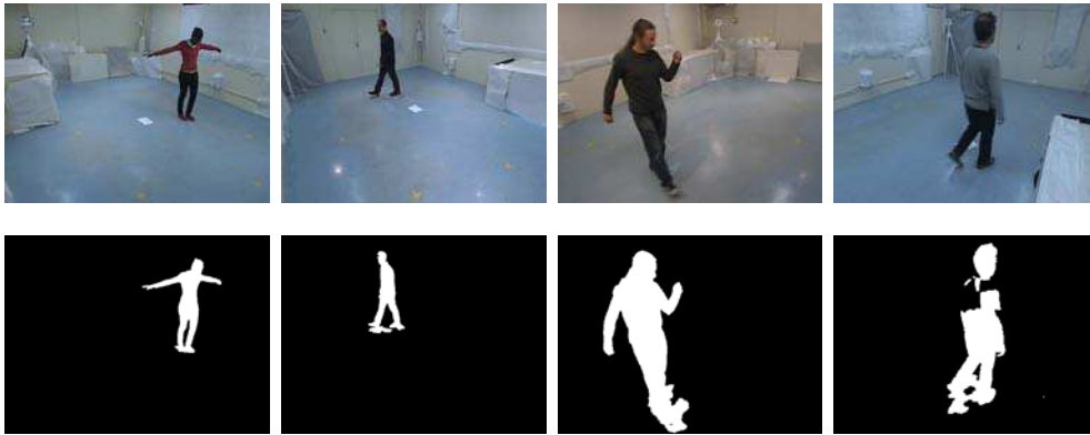
FIG. 2.4 – Exemples de silhouettes extraites par soustraction de fond.
