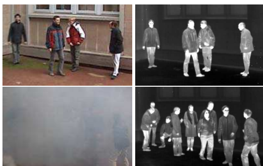
FIG. 1 – Influence de la fumée dans des images couleur et infrarouges. Première ligne : pas de fumée, seconde ligne : zone envahie par la fumée
