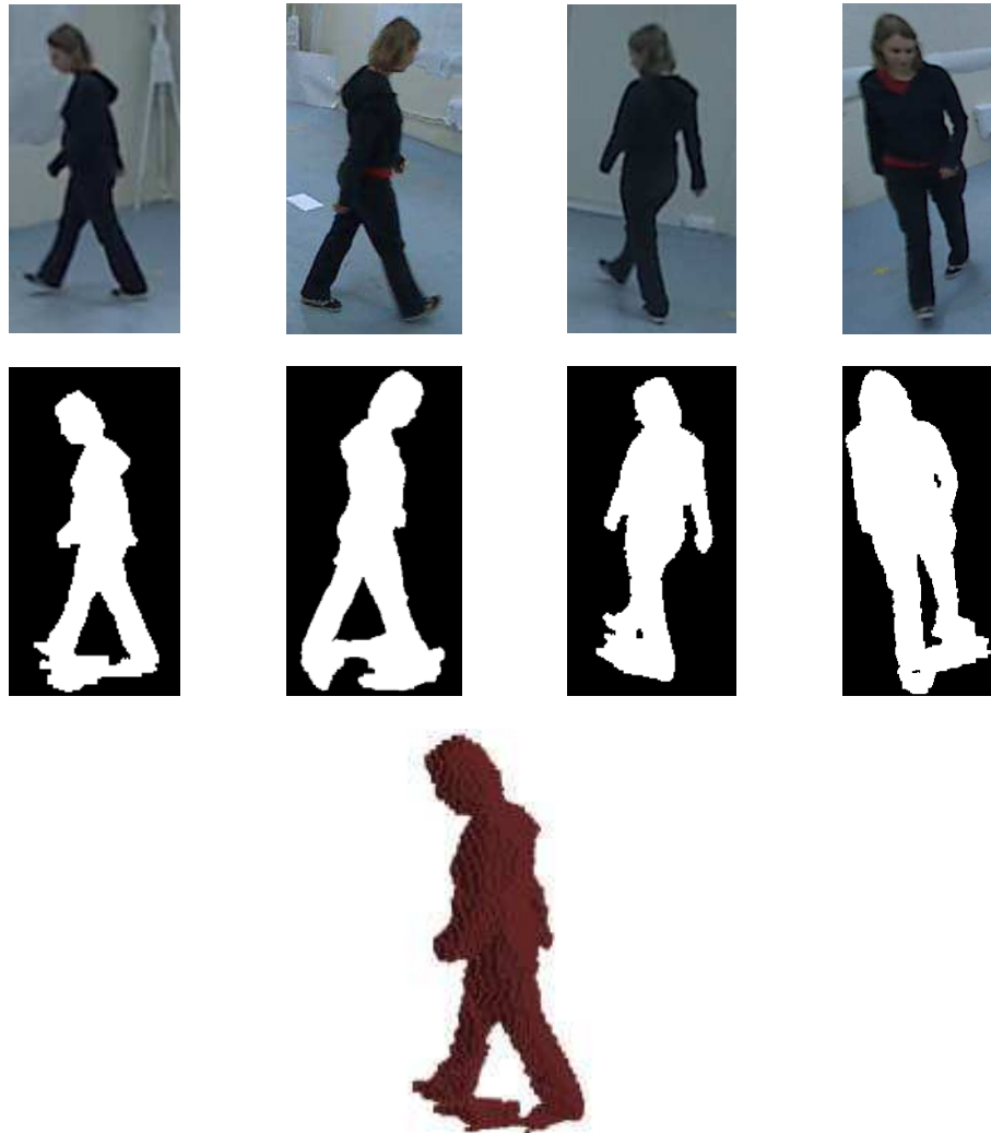
FIG. 2.11 – Effet des ombres au sol sur la reconstruction 3D.
