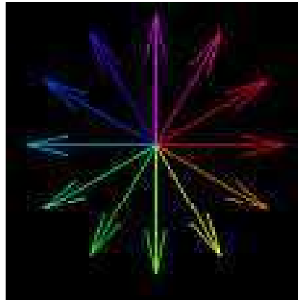
Figure 27 : Codage couleur du flux optique en fonction de l'orientation du vecteur mouvement.
