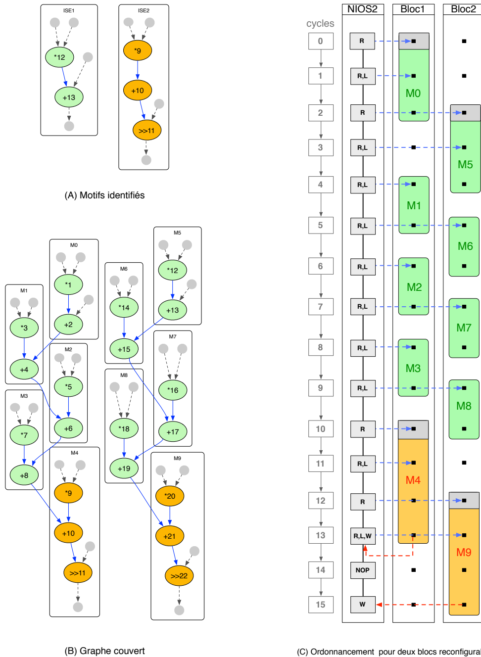
FIGURE 3.19 – Couverture et ordonnancement du cœur de calcul de deux filtres FIR partiellement déroulés. A) Motifs identifiés, B) Couverture du graphe, C) Ordonnancement parallèle des occurrences. Les symboles R,L et W définissent respectivement les tâches de lecture, de lancement et d'écriture du processeur.
