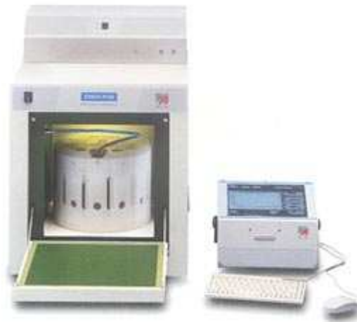
Figure II.14 : Photo du four minéralisateur à micro-onde fermé type Milestone ETHOS PLUS
