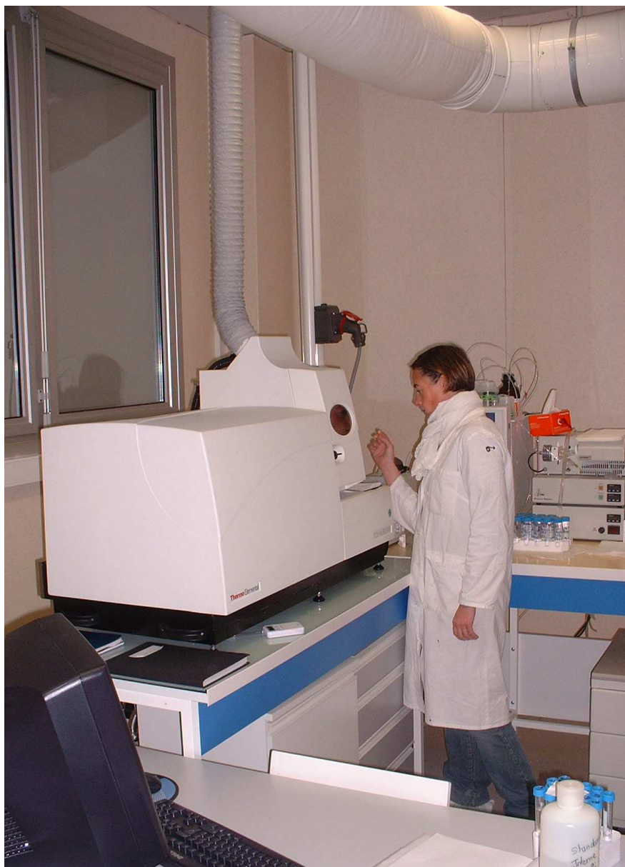
Figure II.9 : Photo de l'ICP- MS utilisé au laboratoire Pierre Süe
