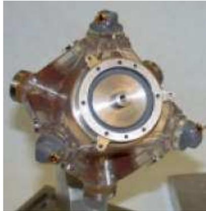
**Figure 6 : Unité de mesure de rotation formée de trois gyromètres laser : le T24 de Kearfott**
