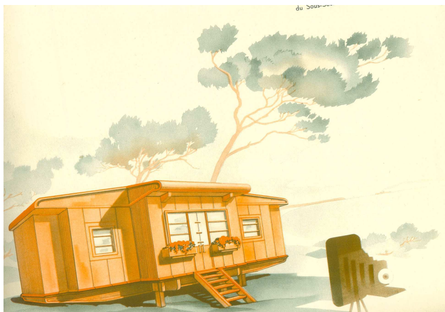
Figure 53. Projet des architectes André Marvie et Jean Guédy, cinquième prix. « Ce modèle est inspiré des constructions de grands véhicules. D'une conception originale qui est bien dans l'esprit de la maison démontable, peu fixée au sol, on peut facilement l'installer dans le site qu'on préfère, sans s'inquiéter du relief. Tous les modèles de ce type ont été conçus pour être édifiés sur tous terrains, en toutes régions, résister aux intempéries et à tous les climats. Leur style leur permet d'être élevés tout aussi bien à la campagne ou au bord de la mer qu'à la campagne 157 ».
