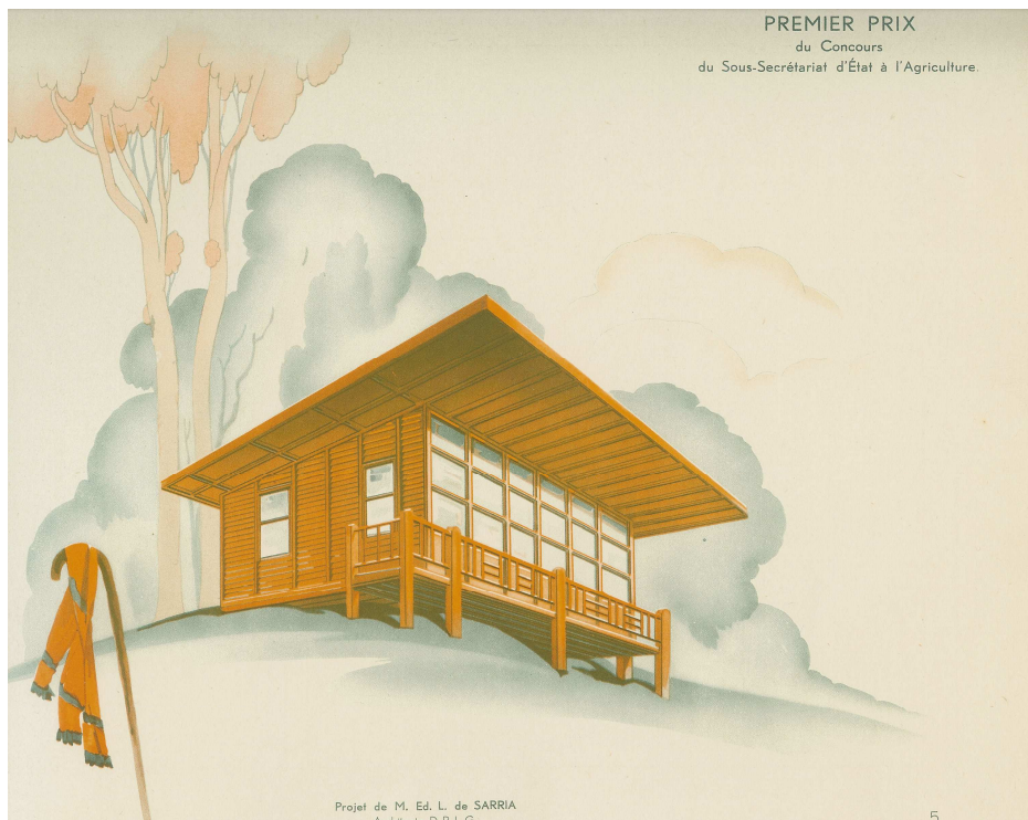
Figure 43. Projet de l'architecte Edmond de Sarria, premier prix. « L'auteur a prévu des éléments standard d'une grande solidité qui permettent de composer l'un des plans qu'on a choisi et de l'agrandir sans difficulté... Pour chaque plot de fondation avec sa semelle clouée, régler les têtes des plots au même niveau, poser ensuite les sablières basses des pignons et façades, en contrôler le niveau et la mise d'équerre, cheviller les assemblages, consolider les angles avec des ferrures en fer galvanisé, remblayer et pilonner tous les trous de plots de fondation, contrôler à nouveau la mise d'équerre et les niveaux 152 ... »
