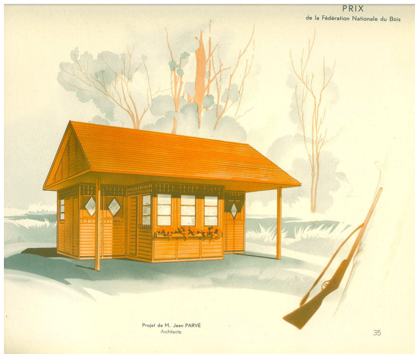
Figure 54. Projet de Jean Prouvé, architecte, prix de la Fondation Nationale du Bois. « L’auteur, tout en cherchant à conserver à la maison un aspect traditionnel avec le toit qui la coiffe, s’est attaché au problème des éléments standards et il a réussi à les mettre au point avec des dispositifs d’assemblage très rapide 158 ».
