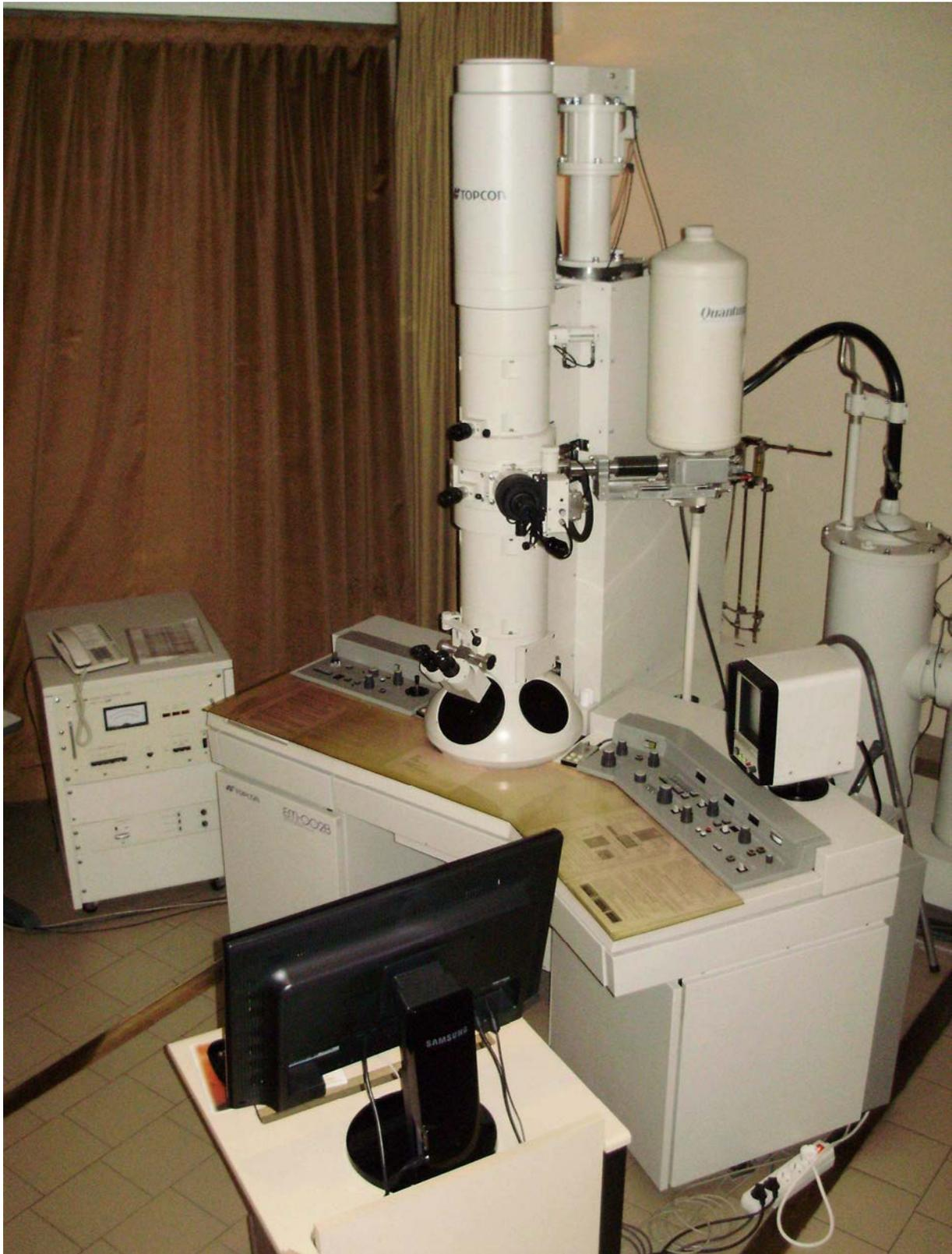
Figure 6 : Photo du microscope électronique à transmission TOPCON
