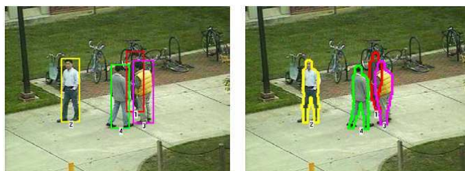
FIG. 2.6 – La détection seule encadre la personne détectée dans une boîte englobante (à gauche) alors que la segmentation donne les contours précis de celle-ci (à droite).
