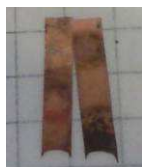
Figure 40 : Collecteur de cuivre en milieu acide (pH = 1)
