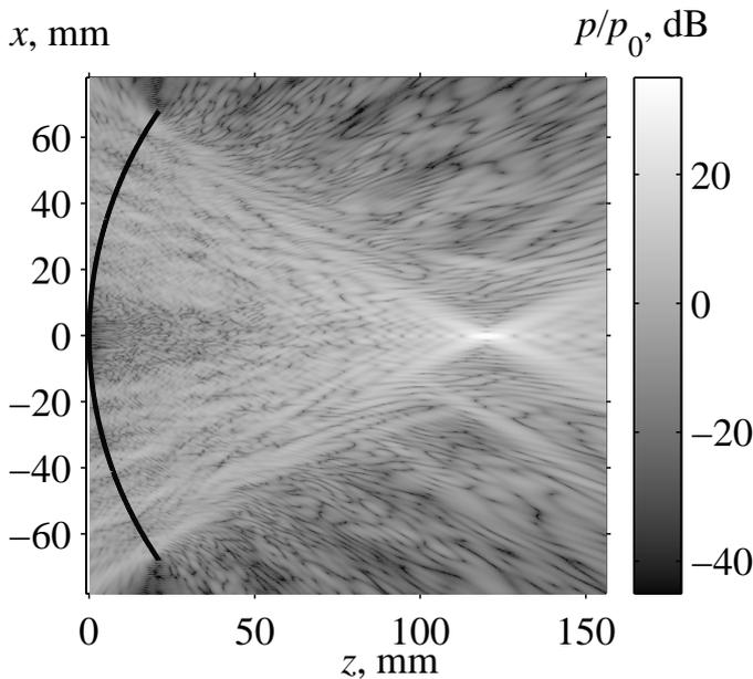
Figure D.14: Répartition de l'amplitude de pression  $p/p_0$  dans le plan  $(x, z)$  sur l'axe de la grille, calculée numériquement dans l'approximation linéaire. La ligne noire indique la position de la surface sphérique du transducteur.
