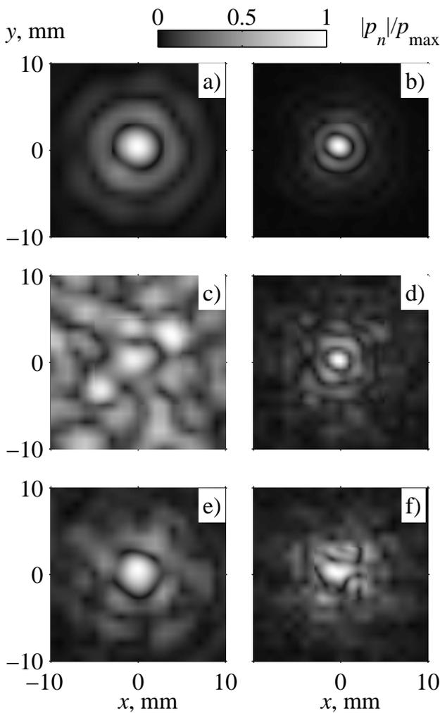
Figure D.12: Amplitude de la première (à gauche) et deuxième (à droite) harmoniques dans le plan focal, mesurées en l'absence d'une couche de phase (a, b), en présence d'une couche de  $180^\circ$  (c, d) et en présence d'une couche de  $90^\circ$  (e, f)
