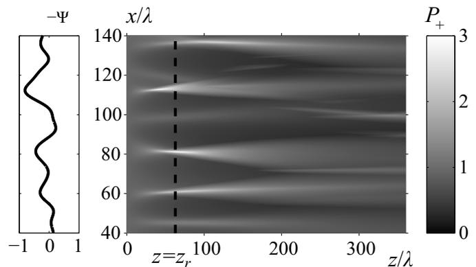
Figure D.8: Exemple de distribution de la pression de pique positive d'onde en  $N$  derrière la couche de phase  $\Psi(x)$ , représenté par la ligne continue sur la gauche. Des paramètres de la couche ont été choisis comme:  $l/\lambda = 6$ ,  $z_r/\lambda = 63$ , la longueur non-linéaire  $z_n = 8z_r$ .
