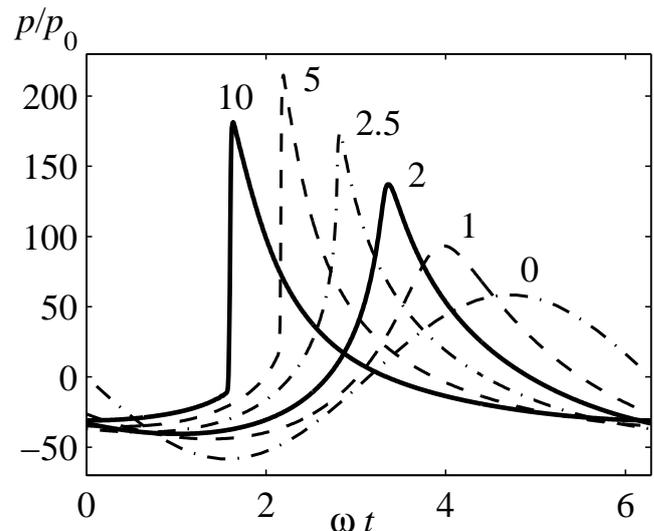
Figure D.15: Des formes d'ondes de pression adimensionnelles au foyer géométrique de la grille à des niveaux d'intensité sur les éléments 1, 2, 2.5, 5 et 10 W/cm<sup>2</sup> dans des simulations non linéaires; 0 – la simulation linéaire.
