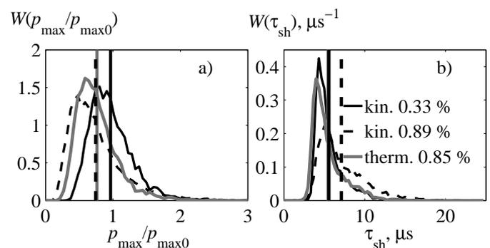
Figure D.6: Comparaison des densités de répartition de la pression maximale normalisée  $p_{\text{max}}/p_{\text{max0}}$  (a) et du temps de montée du choc  $\tau_{\text{sh}}$  (b) pour le cas de la propagation d'onde en  $N$  dans la turbulence cinématique avec  $\mu_{\text{rms}} = 0.89\%$  (ligne noire solide), avec  $\mu_{\text{rms}} = 0.33\%$  (ligne noire en pointillés) et dans la turbulence thermique (ligne grise)
