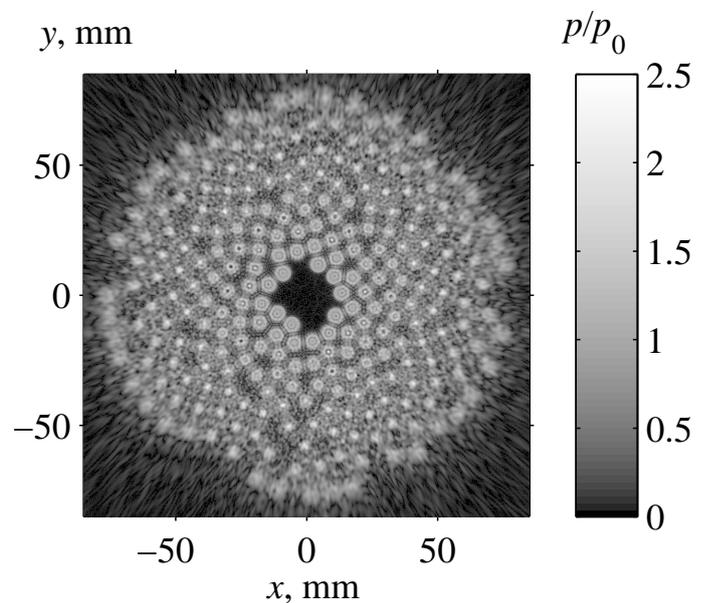
Figure D.13: Amplitude normalisée du champ initial  $p/p_0$  dans le plan  $(x, y, z = 0 \text{ mm})$ . La pression de normalisation est  $p_0 = \rho_0 c_0 u_0$ , où  $u_0$  est l'amplitude de la vitesse vibratoire à la surface d'un élément de la grille.
