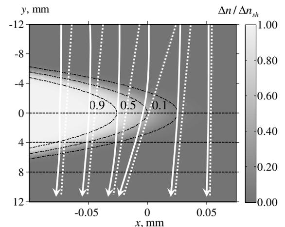
Figure D.3: Schéma de déviation des rayons optiques dans le plan  $xOy$  (flèches pleines) à cause de la propagation de la lumière à travers des inhomogénéités de l'indice de réfraction provoqués par l'onde de choc. Des lignes en pointillés représentent la formation de l'ombre «virtuelle».
