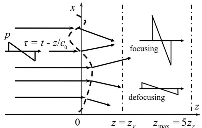
Figure D.7: Propagation d'une onde en  $N$  plane à travers un écran de phase (ligne pointillée), situé à  $z = 0$ . La longueur de réfraction typique de l'écran de phase est désignée comme  $z_r$  et la distance maximale dans les calculs est  $z_{\max}$ .
