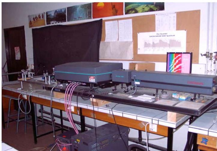
**Figure V. 1** : Laser à colorant pompé par un laser YAG : Nd<sup>3+</sup> à impulsions
