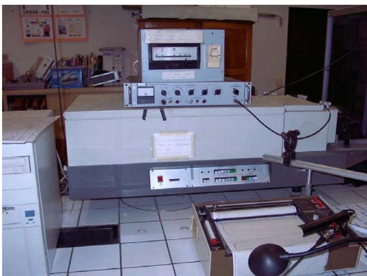
**Figure V. 2** : Système d'échantillonnage du signal (Monochromateur et Boxcar PAR 162/164)
