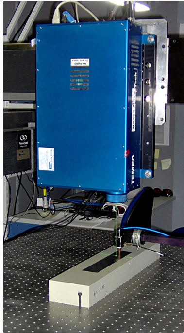
FIG. 3.19 – L'interféromètre laser Bossa Nova TEMPO-FS2000 mesure l'amplitude du déplacement normal à la surface de l'échantillon.
