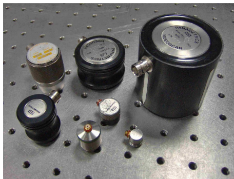
(a) Transducteurs piézoélectriques pour le CND allant de 100 kHz à 5 MHz
