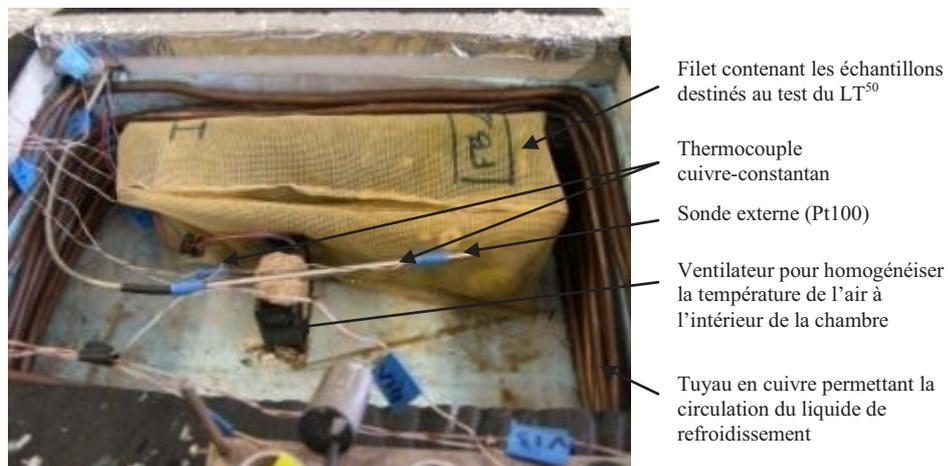
**Figure m.20 : Intérieur d'une chambre de conditionnement.**
