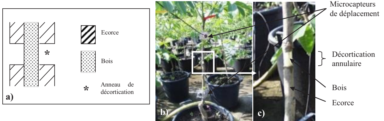
Figure m.9 : Schéma de l'annélation (b) Zone décortiquée des troncs des arbres. On peut observer les capteurs LVDT entourant l'anneau de décortication. (c) Partie zoomée : anneau de décortication.
