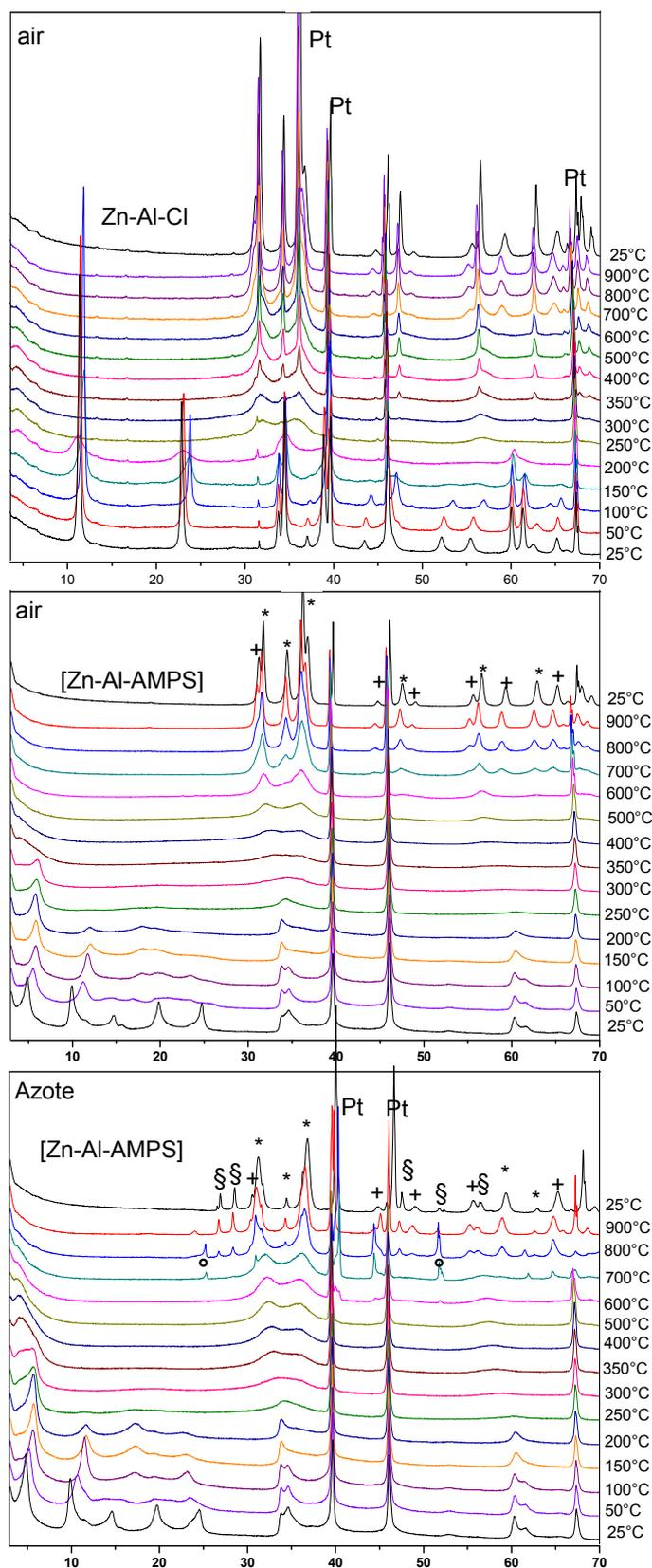
**Fig. 28 a:** Evolution des diffractogrammes X en fonction de la température pour la phase [Zn-Al-Cl] air et [Zn-Al-AMPS] : air et azote. Les symboles : \* représentent ZnO, zincite (PDF/36-1451); +  $ZnAl_2O_4$ , gahnite (PDF/5-0669); § ZnS (PDF/5-0492); °  $ZnAl_2S_4$  (PDF/89-4210).
