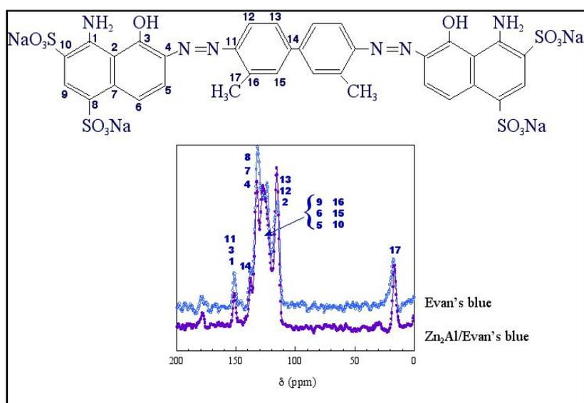
Fig. 18 :  $^{13}\text{C}$ -CP-MAS RMN: de Evans bleu et  $\text{Zn}_2\text{Al/Evan}$
