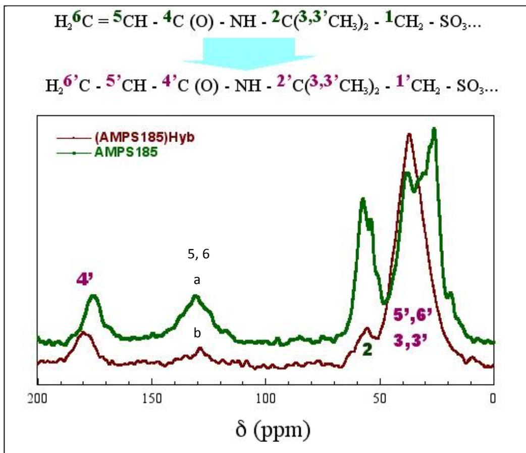
*Fig. 23 : spectres RMN de a)AMPS 185 et b)Zn<sub>2</sub>Al/(AMPS185)*
