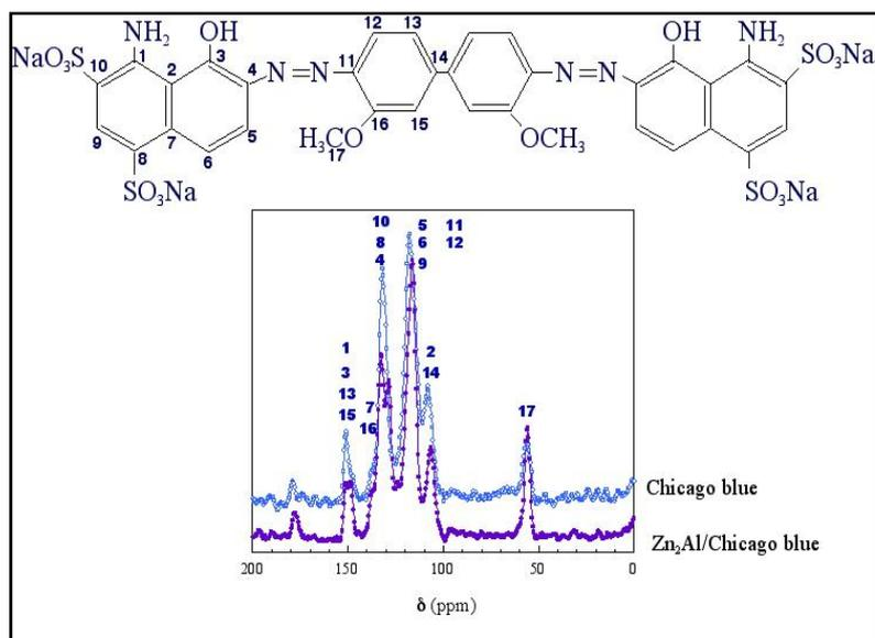
Fig. 17 :  $^{13}\text{C}$ -CP-MAS RMN: de Chicago bleu et  $\text{Zn}_2\text{Al/Chicago}$
