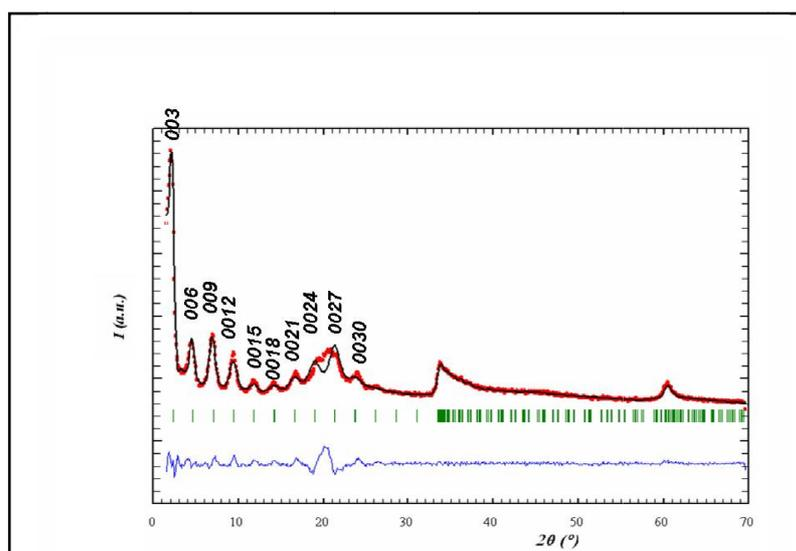
Fig.2 : Diffractogramme de phase coprécipitée avec le MADABS B : Zn<sub>2</sub>Al/MADABS
