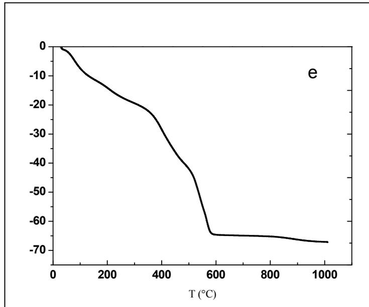
*Fig. 27 : Analyse thermogravimétrique de phase e) H''(C)*
