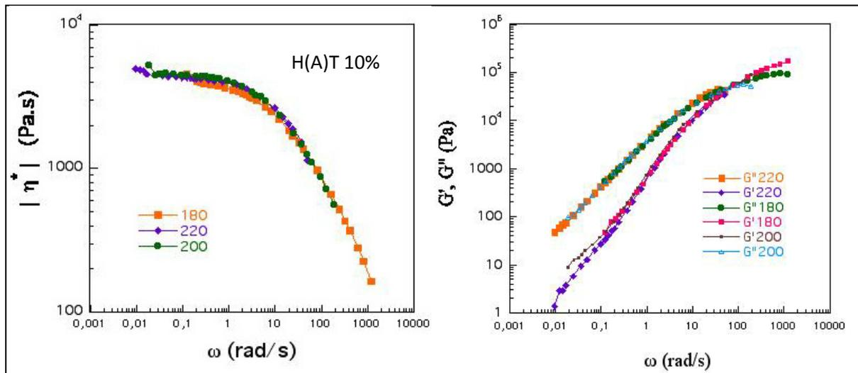
Fig. 53 : Représentation de  $G'$ ,  $G''$  et  $\eta^*$  en fonction de  $\omega$  (rd/s) de PS : H (A)T [10%], pressé à 200°C
