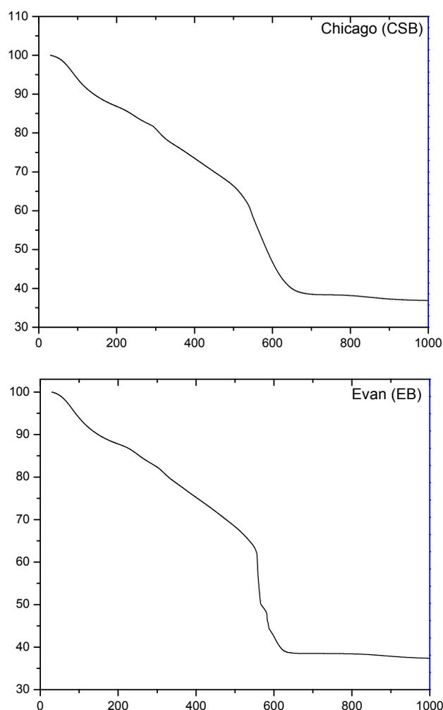
Fig. 11: Analyses thermogravimétriques des phases hybrides a) Zn-Al-Chicago, b) Zn-Al-Evan
