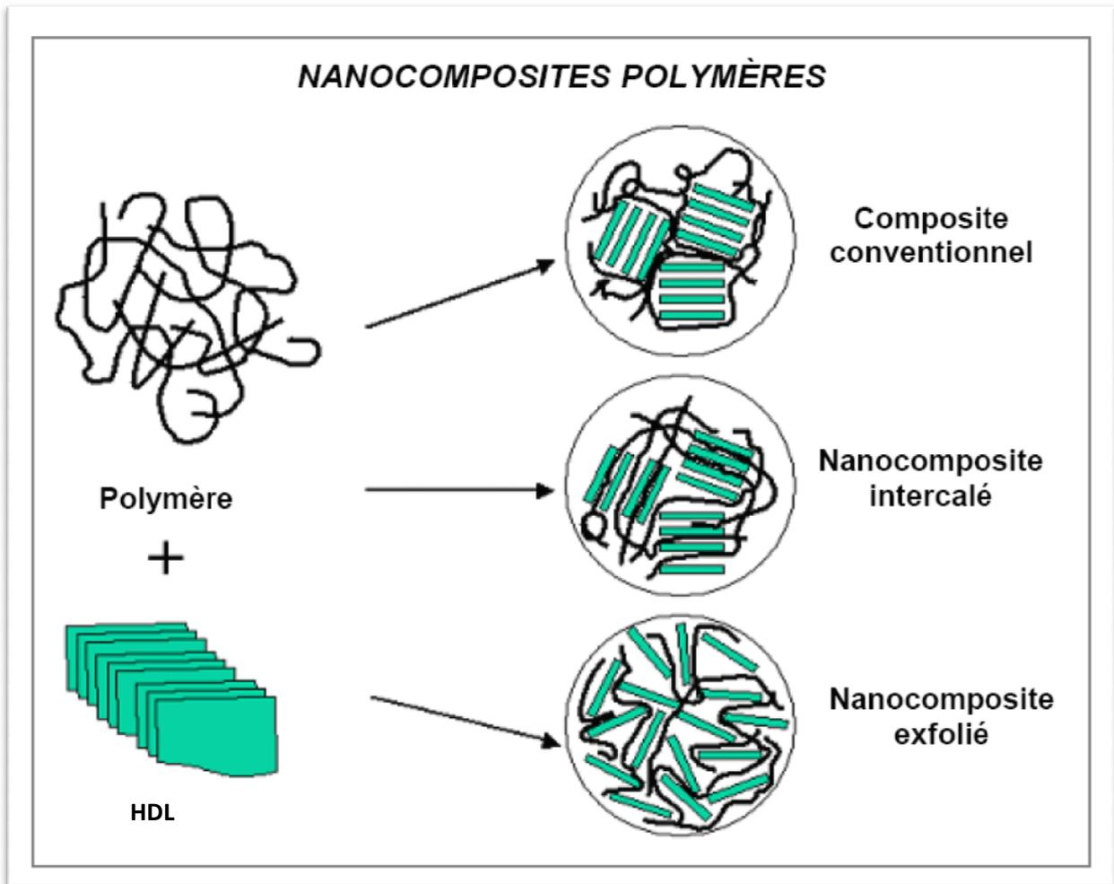
*Fig. 1: microcomposite (1), nanocomposite intercalé (2), nanocomposite exfolié (3)*
