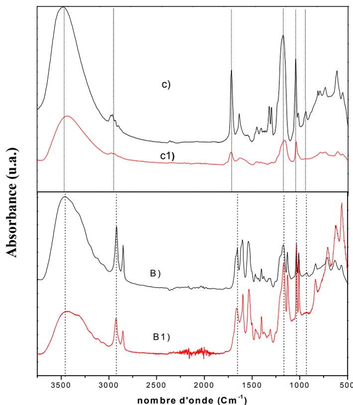
**Fig. 6 : spectre IR des phases C) H(A), C1) H(A)T, B) H(B) ; B1) H(B)T**
