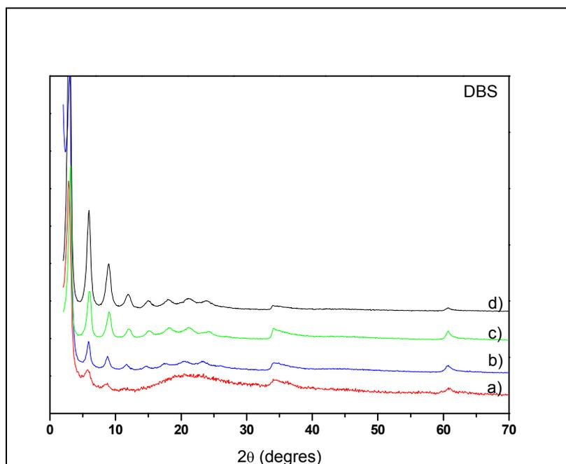
Fig. 26: Diffractogrammes des phases a)  $\text{Zn}_2\text{Al}/(\text{DBS})\text{T}$  ; b)  $\text{Zn}_2\text{Al}/\text{DBS}$  ; c)  $\text{Zn}_2\text{Al}/(\text{DBS})\text{T}$  ; d)  $\text{Zn}_2\text{Al}/(\text{DBS})\text{Tsol}$
