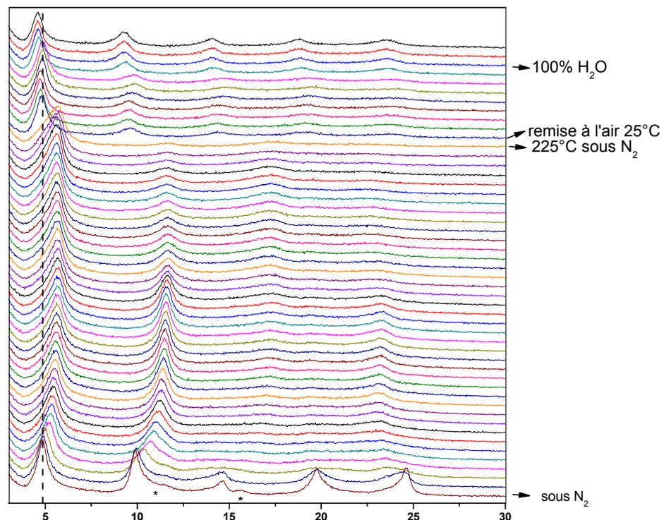
**Fig. 30: Evolution des diffractogrammes X en fonction de la température pour la phase [Zn-Al (AMPS)] : sous azote ; on chauffe jusqu'à 50°C puis de 5°C en 5°C jusqu'à 225°C puis une remise à l'air 25°C enfin on le met sous humidification 100%  $\text{H}_2\text{O}$ , \* :  $\text{Zn}_2\text{AlCl}$**
