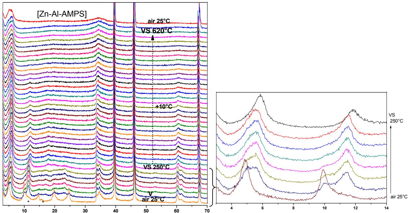
**Fig. 29: Evolution des diffractogrammes X en fonction de la température pour la phase  $[\text{Zn-Al-AMPS}]$  : vide secondaire et en chauffant de  $25^{\circ}\text{C}$  à  $250^{\circ}\text{C}$  puis de  $10^{\circ}\text{C}$  en  $10^{\circ}\text{C}$  jusqu'à  $620^{\circ}\text{C}$  [VS : vide secondaire] ; \* :  $\text{Zn}_2\text{AlCl}$  de départ ; à droite : Zoom**
