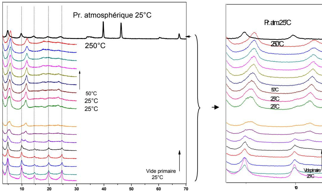
**Fig. 34 : Evolution des diffractogrammes X en fonction de la température pour la phase [Zn-Al-AMPS] : la phase est placée sous vide primaire après on chauffe de 5°C en 5°C jusqu'à 250°C toujours sous vide primaire.**
