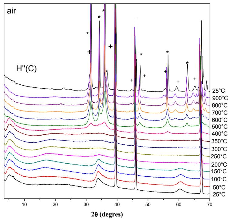
**Fig. 28b: Evolution des diffractogrammes X en fonction de la température pour la phase  $[H'(C)]$  air et  $[H''(C)]$  : air. Les symboles : \* représentent  $ZnO$ , zincite (PDF/36-1451); +  $ZnAl_2O_4$  gahnite (PDF/5-0669).**
