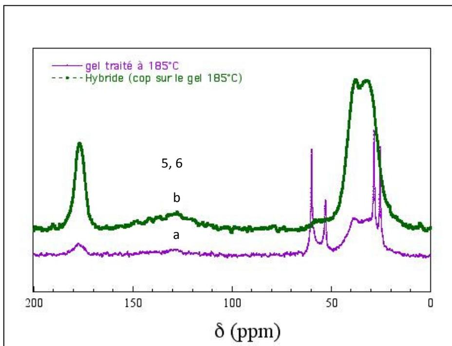
Fig. 24 : spectres RMN de a) gel traité à 185°C et b) Zn<sub>2</sub>Al/(AMPS)Tsol
