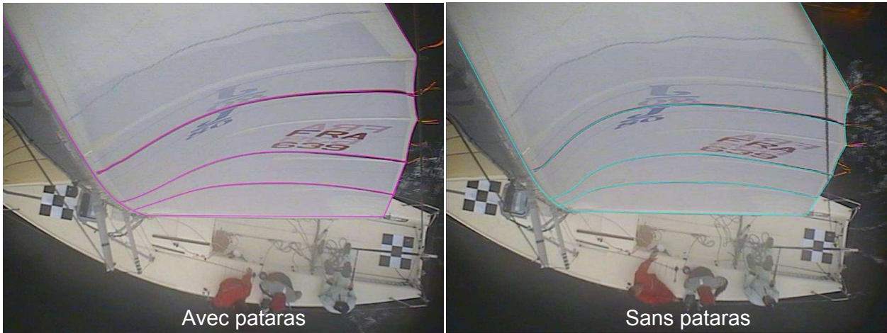
Figure 4.26 – Comparaison du flying shape expérimental et du résultat de la simulation stationnaire avant et après un choqué de pataaras. Les photographies en fond sont enregistrées en mer. Le résultat des simulations est représenté en rose pour le calcul avec pataaras et en bleu clair sans pataaras
