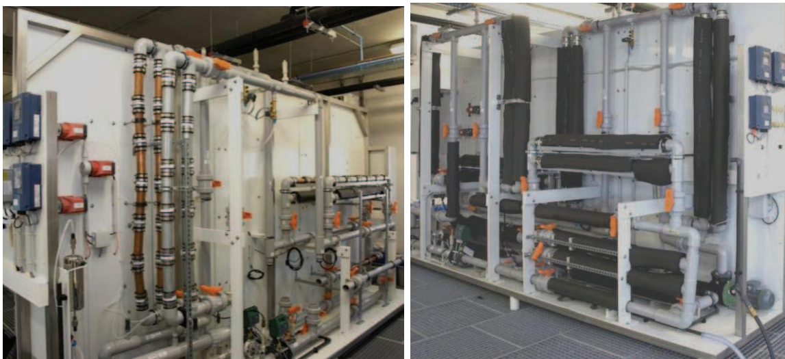
Figure 10 : Ligne d'acier galvanisé sans injection de filmogène et ligne de cuivre de référence (a). Lignes doubles PERT/Al/PERT et PVCc d'étude et de référence (b).
