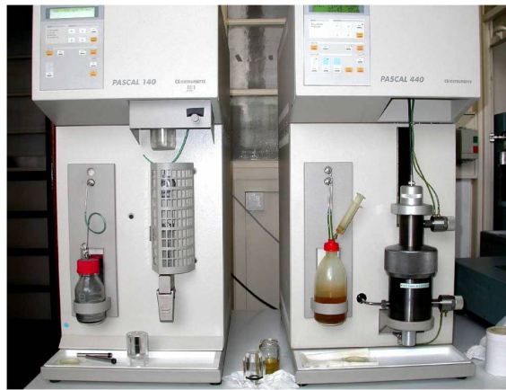
FIGURE 3.2 – Porosimètre au mercure du groupe MDM (Ifsttar).
