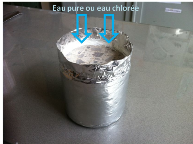
FIGURE 5.4 – Préparation des éprouvettes de béton M25 pour un essai d'imbibition. Mise en place d'un réservoir pour l'imbibition.
