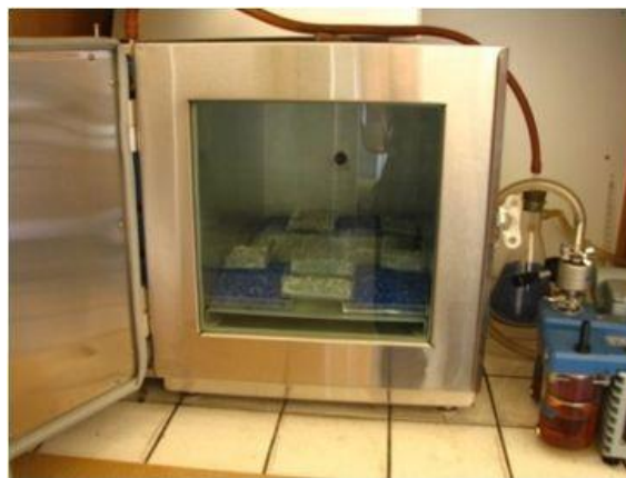
FIGURE 3.3 – Traitement des échantillons en étuve sous vide à 45 °C (méthode dite de référence [33] [35]).
