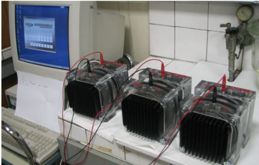
FIGURE 3.13 – Essai de migration accéléré sous champs électrique.
