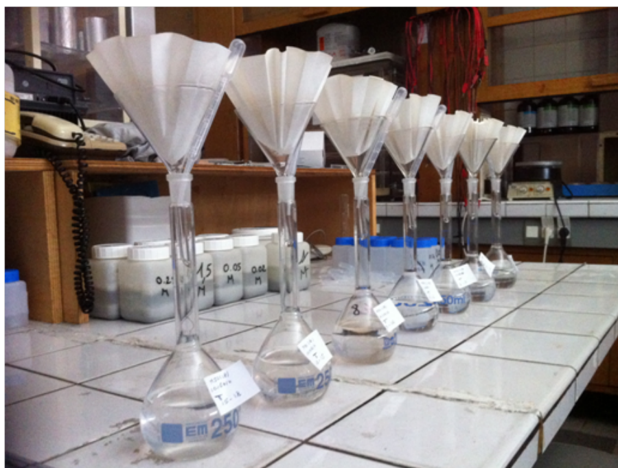
FIGURE E.2 – Filtration des solutions après l’attaque à l’eau et l’attaque à l’acide.
