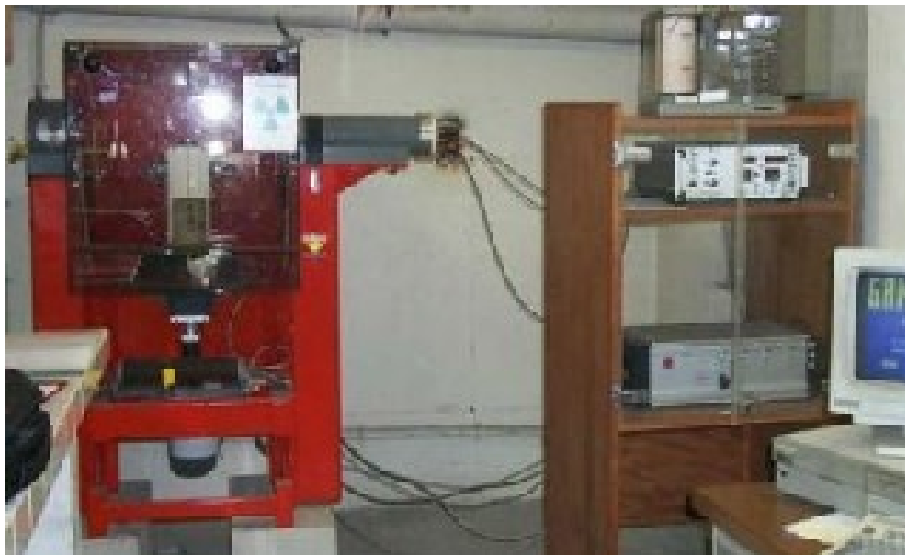
FIGURE G.1 – Le dispositif de gammadensimétrie à l'IFSTTAR.
