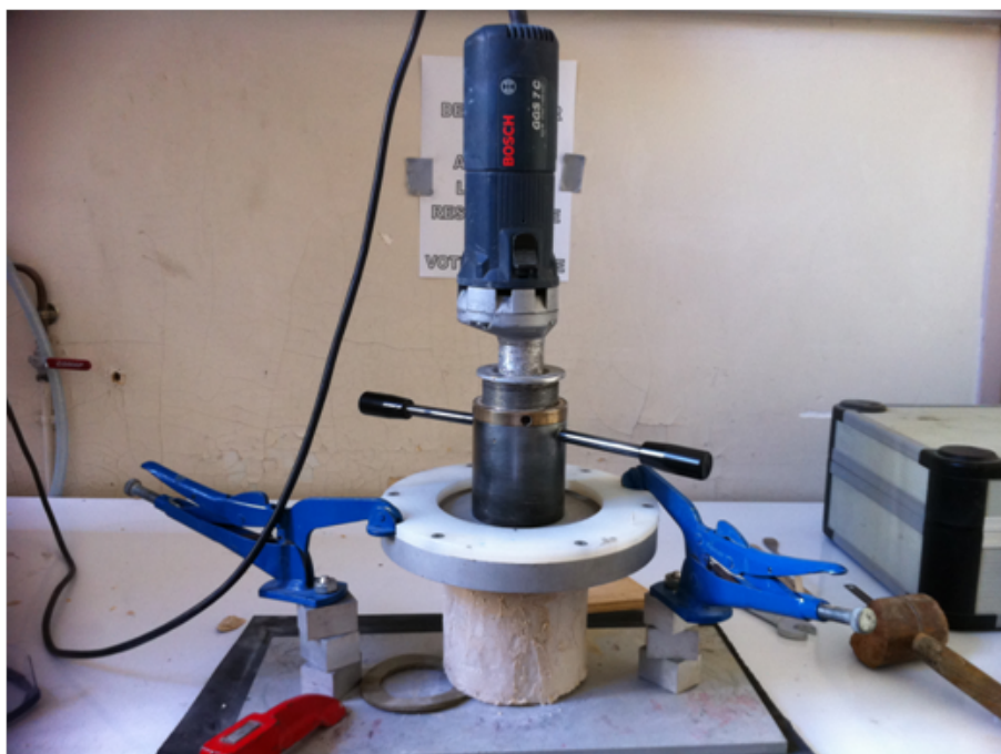
FIGURE E.1 – Grignotage des éprouvettes issus des essais de diffusion.
