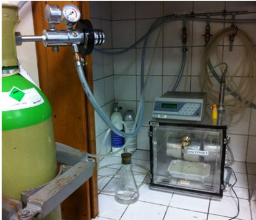
FIGURE 5.2 – Carbonatation accélérée des éprouvettes de béton M25 dans une enceinte où la concentration de \text{CO}_2 est fixée à 10 % et HR = 53,5 %.
