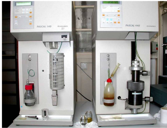
FIGURE 3.2 – Porosimètre au mercure du groupe MDM (Ifsttar).
