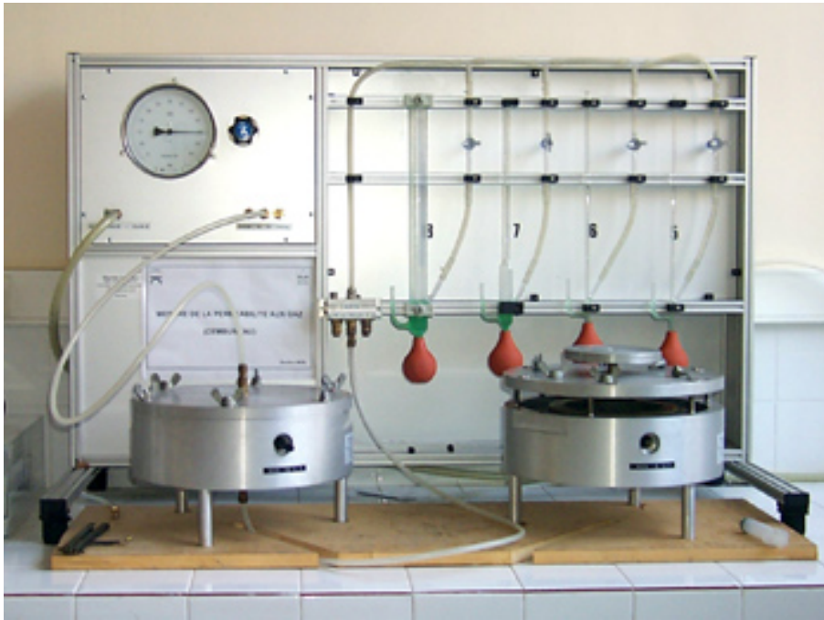
FIGURE D.1 – Mesure de la perméabilité aux gaz
