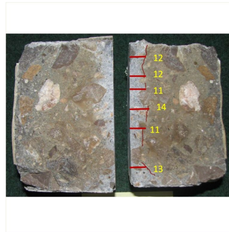
FIGURE 4.3 – Profondeur de pénétration pour le béton BO : exposé pendant 90 jours à 30 \text{ g.L}^{-1} de NaCl. Age du béton au début d'essai : 10 mois.
