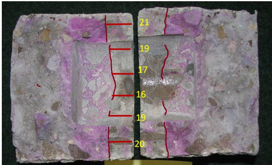
FIGURE 5.6 – Mesure de la profondeur de carbonatation par pulvérisation de phénolphthaléine sur l'éprouvette PC-s (partiellement carbonatée) du béton M25, après une exposition à 10 % de \text{CO}_2 à HR = 53,5 % pendant 14 jours.
