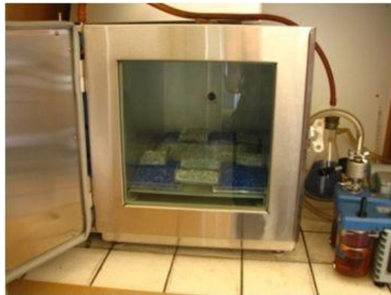
FIGURE 3.3 – Traitement des échantillons en étuve sous vide à 45 °C (méthode dite de référence [33] [35]).
