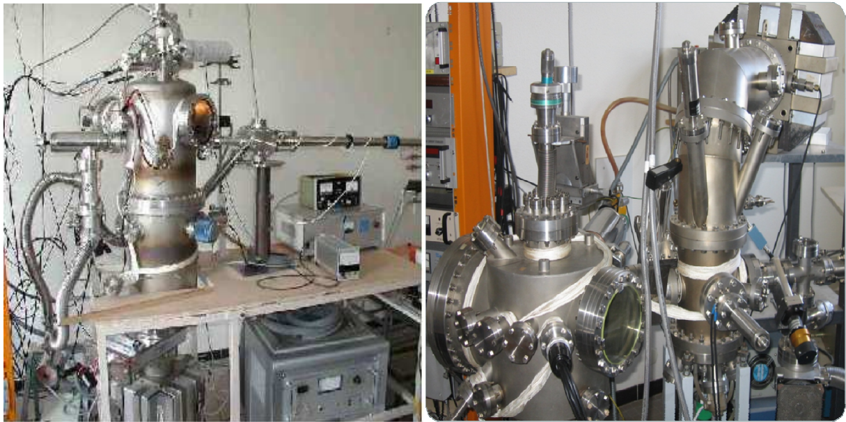
Figure 1.1 : Photographies des deux bâtis ultravides d'analyse
