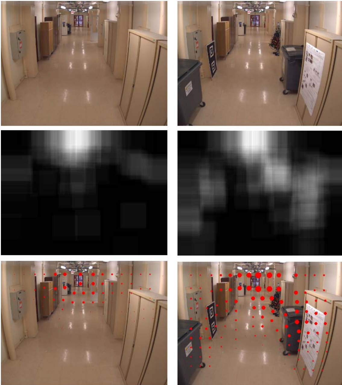
FIGURE 3.10: La première ligne représente la scène observée par la caméra statique : un couloir. La ligne du milieu représente l'estimation non paramétrique (méthode des fenêtres de Parzen) de la densité de probabilité des points d'intérêt dans I_s . La ligne du bas montre la grille extraite de I_s , plus les cercles sont importants et plus la densité de probabilité est importante.
