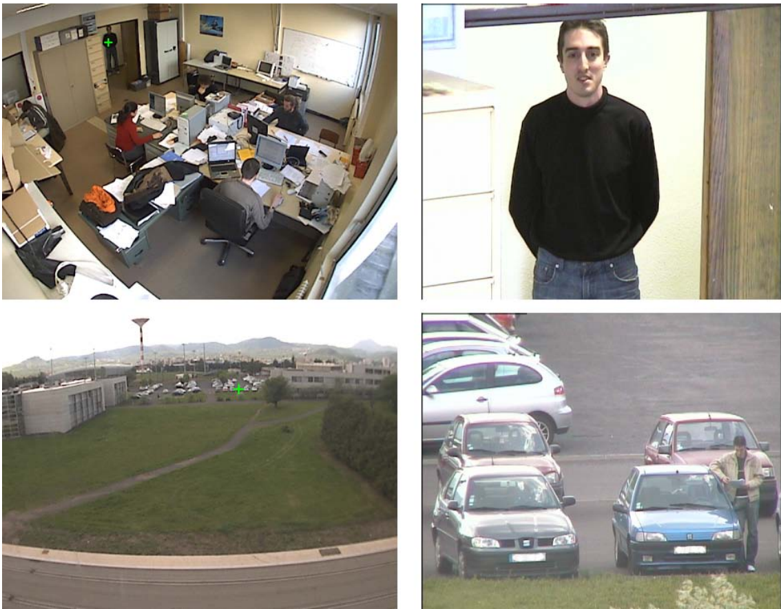
FIGURE 3.11: Exemples d'images résultant de l'application directe de la méthode de calibrage en intérieur (première ligne) et en extérieur (dernière ligne). La croix dans les images de la caméra statique (colonne de gauche) représente le position sur laquelle on veut centrer la caméra dynamique. Les images obtenues avec la caméra dynamique (colonne de droite) permet d'envisager des applications de reconnaissance.
