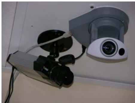
FIGURE 4: Illustration du positionnement choisi pour les deux caméras composant notre système hybride de vision : à gauche, une caméra statique et à droite, une caméra Pan-Tilt-Zoom.
