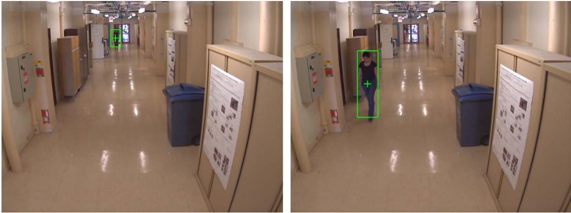
FIGURE 5.5: Résultats de la soustraction de fond fondée sur la méthode d'histogramme couleur proposée par Chen et al. [23].
