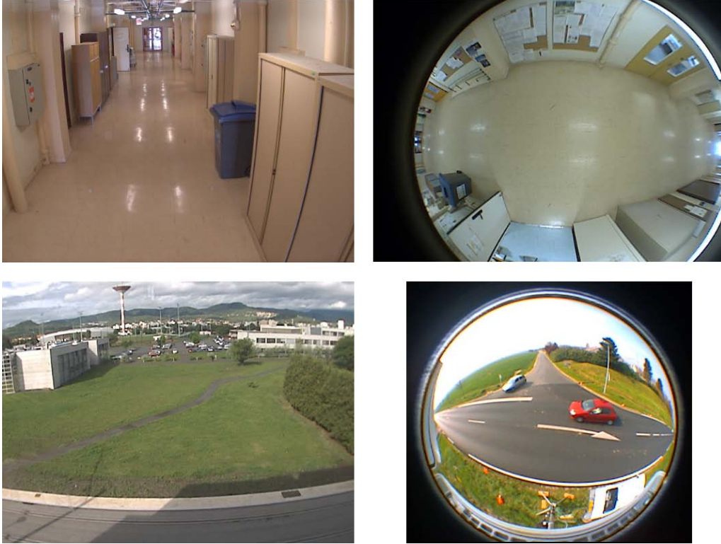
FIGURE 2: Vues issues de différentes caméras statiques dans le cas de scènes en intérieur (première ligne) et en extérieur (seconde ligne) : colonne de gauche, une caméra perspective classique, colonne de droite une caméra statique avec un objectif fisheye.
