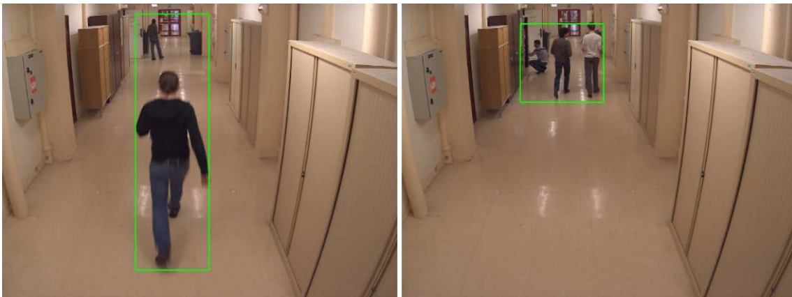
FIGURE 5.9: Cas de détection dans lequel plusieurs personnes sont dans un même blob (fusion de blob).
