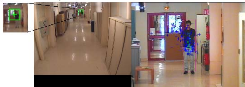
FIGURE 6.5: Résultat du suivi de personne basé sur la collaboration entre les capteurs : cas où plusieurs personnes sont présentes dans un même blob et cas où il y a une détection incomplète de la personne dans l'image de la caméra statique (à gauche), compensée par la caméra dynamique.
