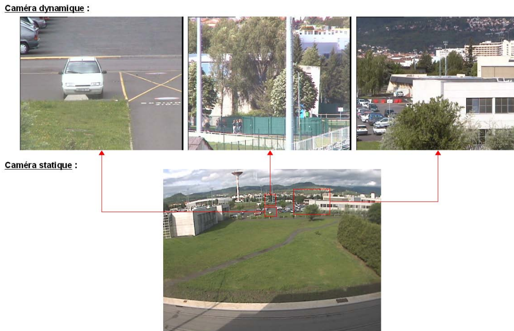
FIGURE 3: Exemples de vues hautes résolutions obtenues avec une caméra dynamique pour un fort zoom de différentes zones d'une scène observée par une caméra statique.
