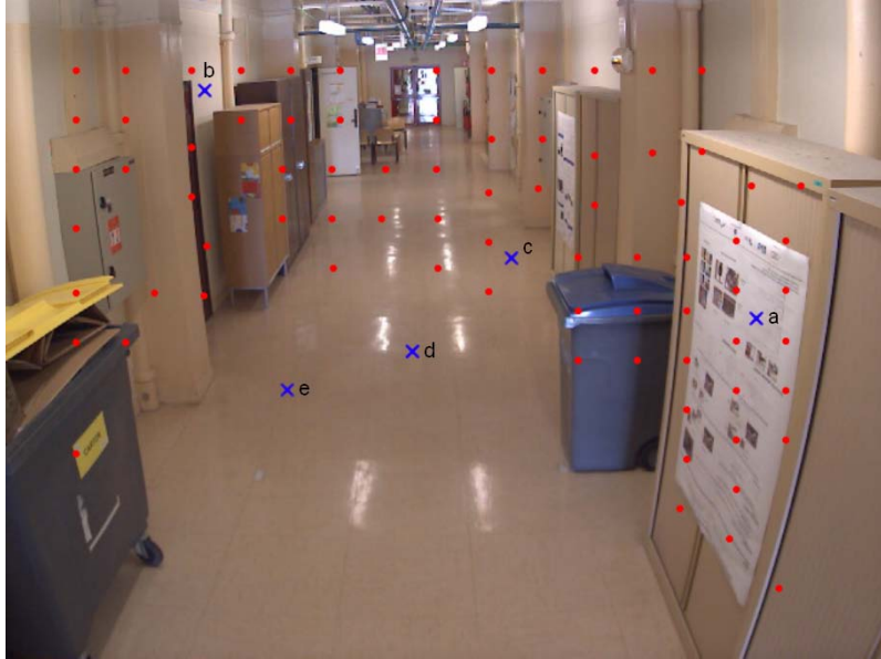
FIGURE 3.9: Les croix représentent les points interpolés pour lesquels on va estimer la précision globale de notre calibrage. Les points représentent les point du quadrillage qui ont pu être appris lors de la première étape du calibrage.
