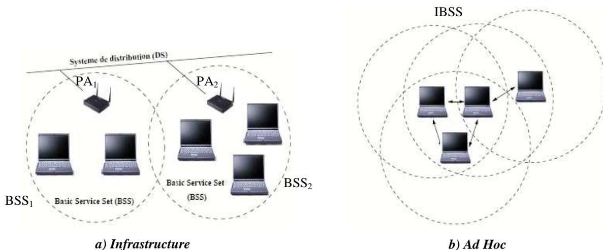
Figure I.3 : Modes de fonctionnement des réseaux WLAN
