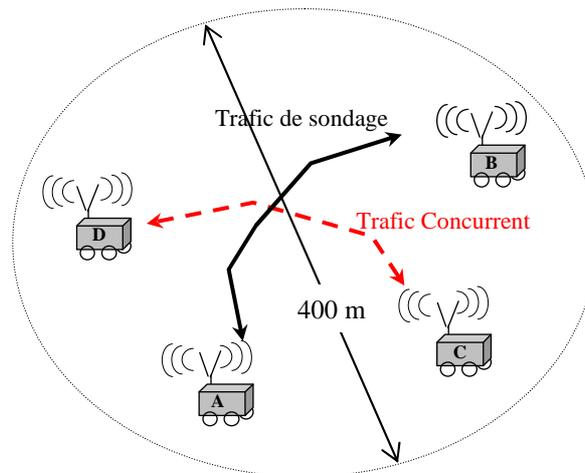
Figure.III.2 : La topologie du réseau sans fil.
