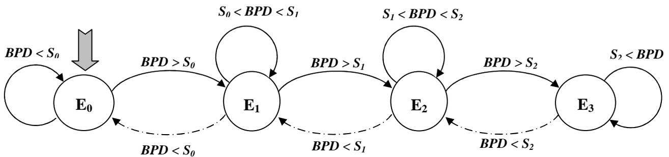
Figure IV.18 : L'automate de gestion d'émission Adaptatif
