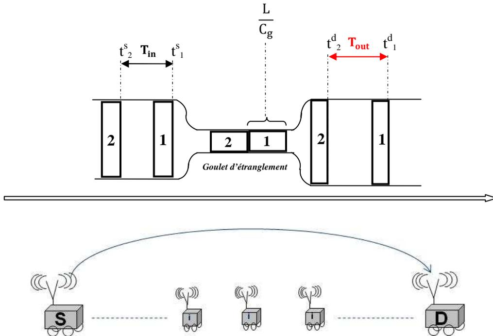
Figure II.1 : Principe de la dispersion de paquets
