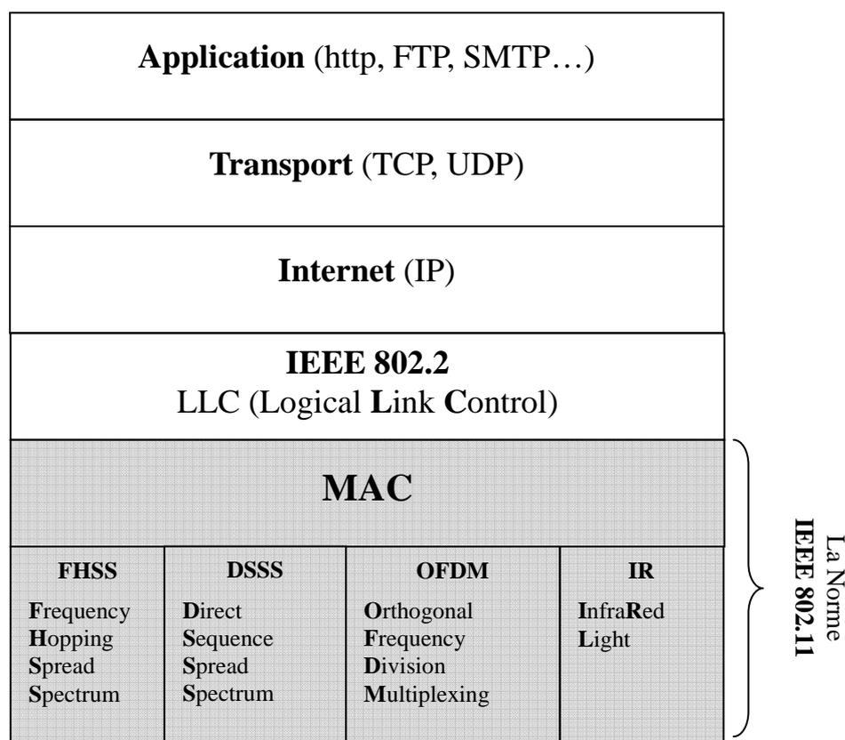
Figure I.2 : Les couches physiques dans la norme IEEE 802.11
