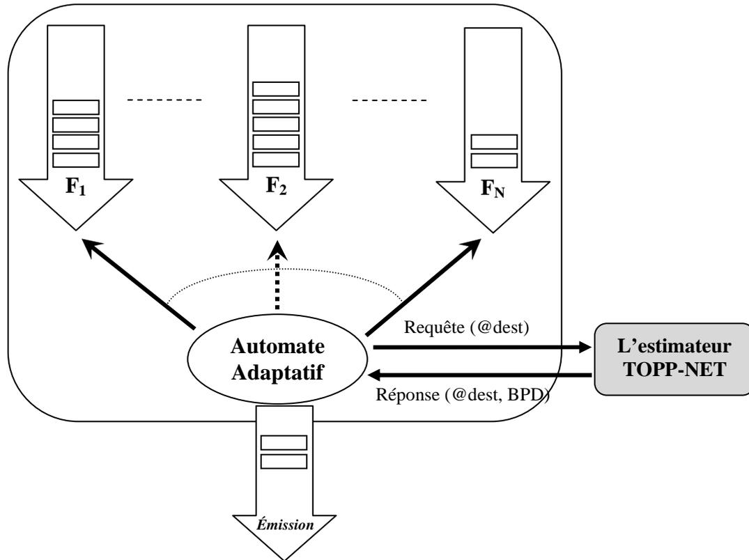
Figure IV.17 : Protocole d'émission adaptatif utilisant l'estimateur TOPP-NET
