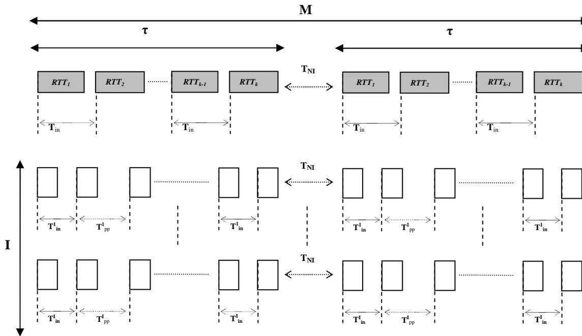
Figure.III.7 : Le modèle de sondage dans la technique TOPP-NET.
