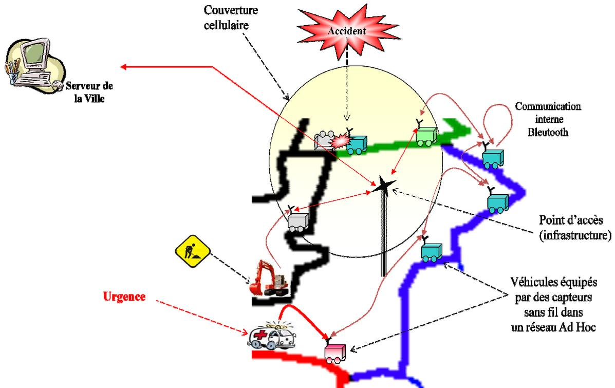
Figure I.7 : Exemple d'un réseau Ad-Hoc civil
