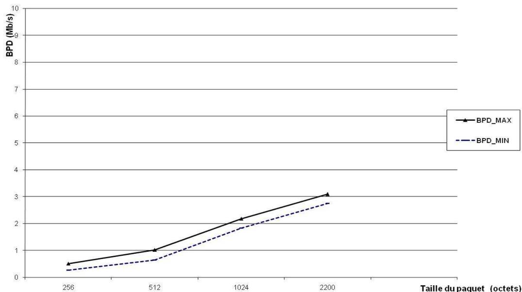
Figure II.13 : IEEE 802.11, L'évolution de la BPD en fonction de la taille des paquets. Le débit du *Trafic concurrent* est 2Mb/s.
