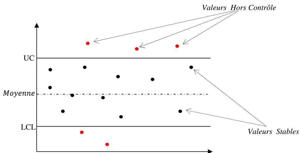
Figure IV.3 : Carte de contrôle de CSP
