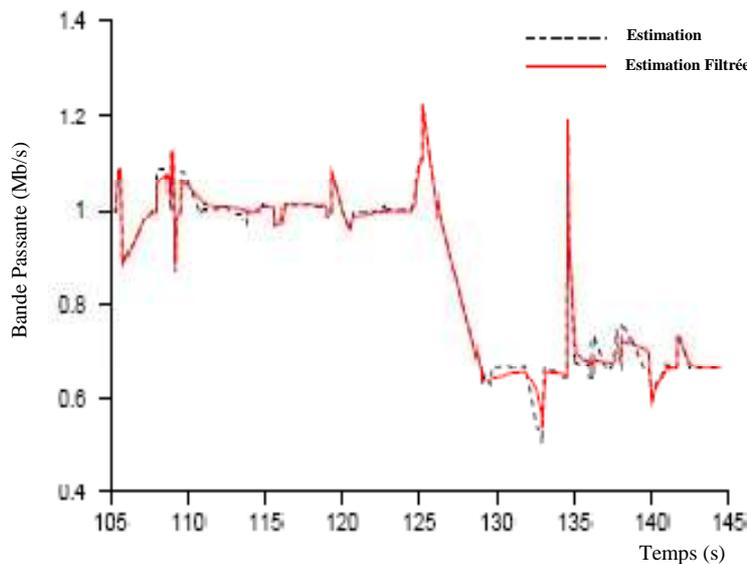
Figure IV.2 : Exemple du Filtre d'Erreur [Kim 2001]
