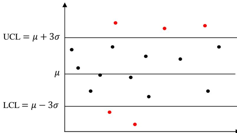
Figure IV.4 : Carte de contrôle de CSP avec les limites de 3-Sigma
