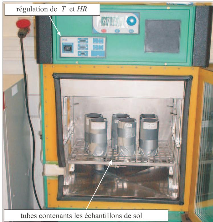
FIG. 3.3 – Enceinte climatique "BIA" contenant des échantillons de sol
