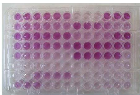
Figure 82 Plaquette 96 puits : dosage du fer total dans une série d'échantillons
