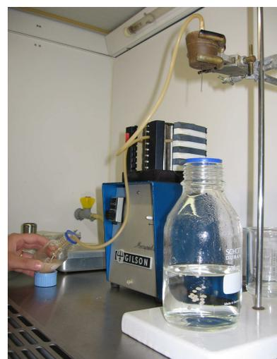
Figure 71 (en haut) Système mis en place pour la formation des billes d'alginate : à gauche, la solution contenant l'alginate dissous et les bactéries ; au centre dans le fond, la pompe péristaltique ; en premier plan à droite le flacon contenant une solution de  $\text{CaCl}_2$  à 0,2 M – (en bas) bille d'alginate contenant les bactéries
