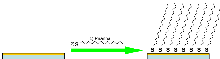
Figure 63 : Fonctionnalisation préalable de la surface dorée
