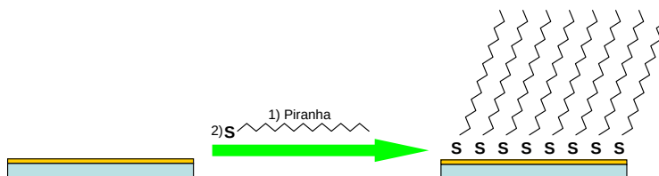
Figure 63 : Fonctionnalisation préalable de la surface dorée
