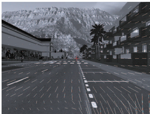
FIGURE 5.24 – Image issue d’une séquence simulée, le flot optique est calculé par la méthode FOLKI et le FoE par la c-vélocité inverse
