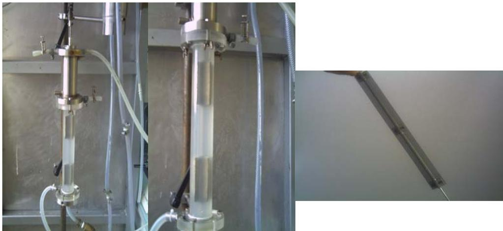
**Figure II.12** : Photos de la colonne en plexiglas et du module d'agitation.
