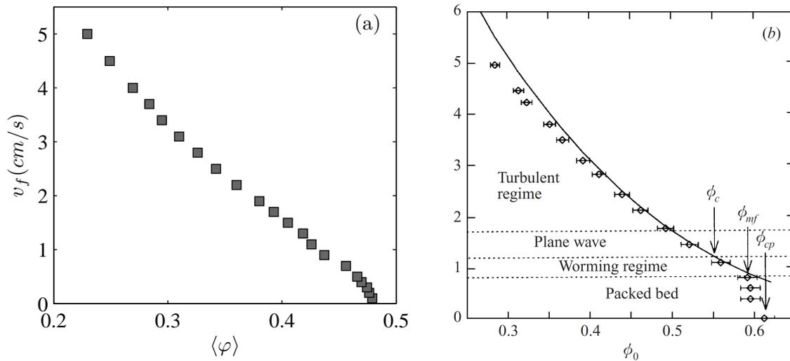
FIGURE A.7 – Courbe d’expansion : vitesse imposée  $v_f$  en bas du domaine en fonction de la fraction volumique correspondante. La figure (a) correspond à nos simulations et la figure (b) a été obtenue expérimentalement dans des conditions similaires [Duru *et al.*, 2002].
