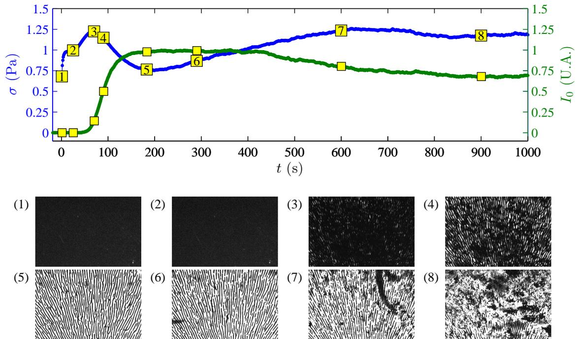
FIGURE 4.18 – Contrainte  $\sigma$  et intensité lumineuse moyenne  $I_0$  au cours du temps pour un gel de noir de carbone de concentration  $C=2\%$  cisailé à  $\dot{\gamma}=0,5 \text{ s}^{-1}$  en plan-plan avec un gap  $h=150 \mu\text{m}$ . Les images (1–8) ont été prises à différents instants indiqués par les carrés sur les courbes.
