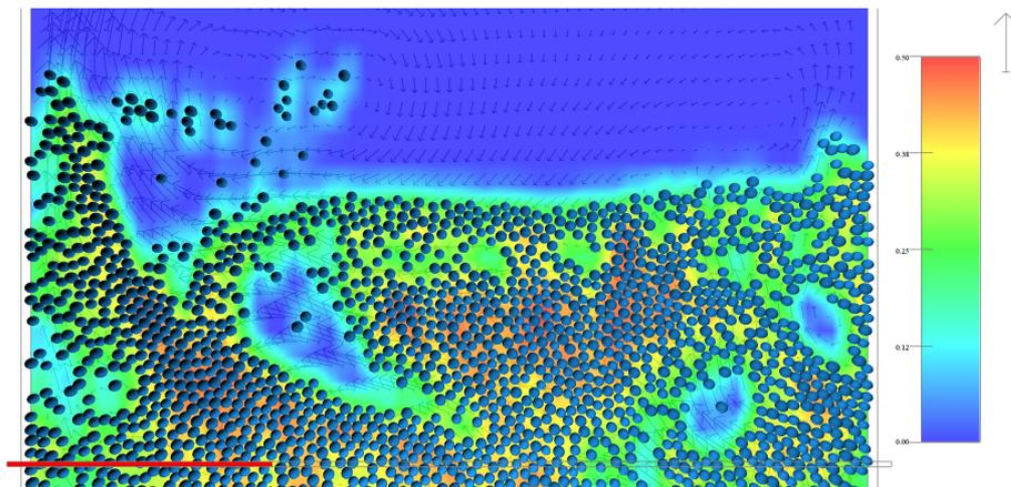
FIGURE A.5 – Exemple de champ de vitesse (représenté par les flèches), de compacité (représenté par la couleur, de 0 à 50%) et de position des grains dans une simulation. La largeur du domaine est 7,2 cm et la figure représente une tranche d'environ 3 cm. La vitesse imposée en bas du domaine est de 3 cm/s. La flèche en haut à droite donne l'échelle de vitesse et correspond à 40 cm/s.
