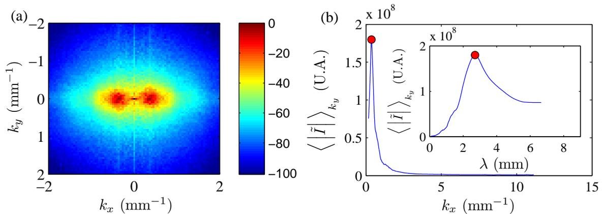
FIGURE 3.10 – (a) Transformée de Fourier  $\tilde{I}$  (en dB) à deux dimensions d'une image de suspension de billes de verre à 4% structurée à  $\dot{\gamma} = 20$  s<sup>-1</sup> dans une cellule de couette. (b) Moyenne selon  $k_y$  de la transformée de Fourier présentée en (a). L'insert de la figure (b) représente les mêmes données en fonction de la longueur d'onde  $\lambda = 1/k_x$ .
