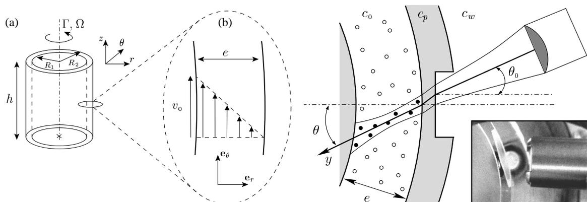
FIGURE 6.4 – À gauche : schéma représentant la géométrie de Couette utilisée. À droite schéma représentant le positionnement du transducteur ultrasonore. L'angle  $\theta$  est nécessaire pour obtenir une projection non nulle de la vitesse selon l'axe  $y$ . Figures extraites de [Manneville *et al.*, 2004]
