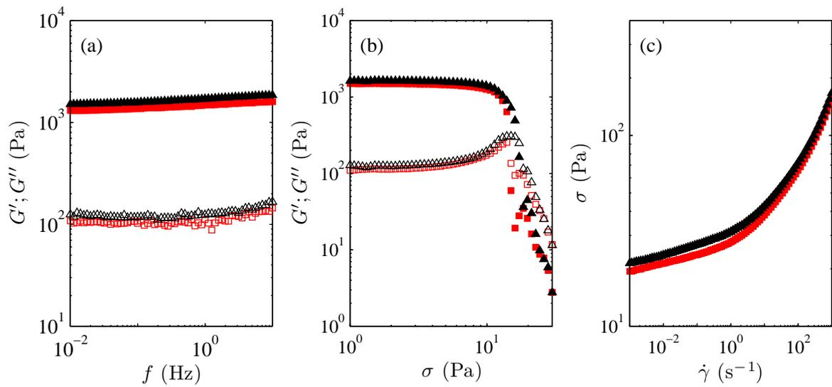
FIGURE 6.11 –  $G'$  (symboles pleins) et  $G''$  (symboles vides) (a) en fonction de la fréquence à 2 Pa et (b) en fonction de la contrainte à 1 Hz pour des gels de noir de carbone à 6% avec billes de verre (▲) et sans billes de verre (■). (c) Courbe d'écoulement : contrainte  $\sigma$  en fonction du taux de cisaillement  $\dot{\gamma}$ .
