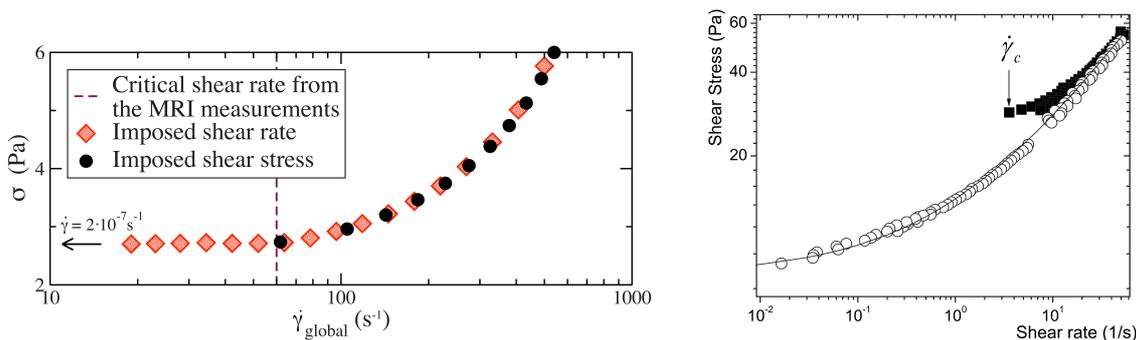
FIGURE 1.4 – Exemples de courbes d’écoulement expérimentales pour des fluides à seuil : (a) suspension de particules colloïdales dans de l’eau salée [Møller *et al.*, 2008] et (b) émulsion d’eau dans de l’huile en présence de Bentonite (■) et sans Bentonite (○) [Ragouilliaux *et al.*, 2007].
