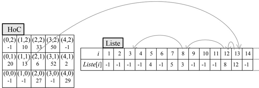
FIGURE 5.3 – Schéma illustrant la méthode des cellules liées. Si on regarde par exemple la cellule (1,1),  $HoC[1][1]$  nous indique que la cellule contient la particule  $i = 13$ , ensuite  $Liste[13] = 12$ , donc la particule 12 est aussi dans la cellule (1,1), puis la particule 8 et enfin la 3.  $Liste[3] = -1$  ce qui indique que l'on a fini : toutes les particules de cette cellule ont été trouvées.
