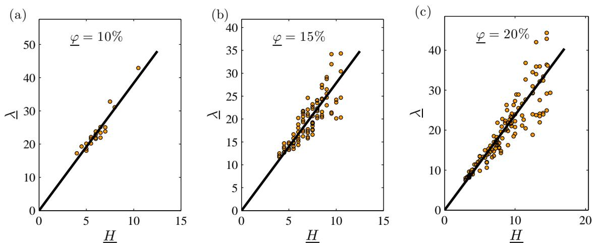
FIGURE 5.13 – Longueur d'onde  $\lambda$  en fonction de la hauteur de confinement  $H$  pour trois fractions volumiques  $\varphi$  : (a) 10, (b) 15, et (c) 20%. Les droites sont des ajustements linéaires de pente (a) 3,8 ; (b) 2,8 ; (c) 2,4.
