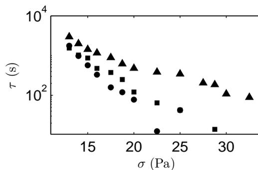
FIGURE 8.5 – Temps au bout duquel l'échantillon glisse au niveau du rotor ( $\tau_R$  ●), au niveau du stator ( $\tau_S$  ■) et au bout duquel l'échantillon est complètement fluidifié ( $\tau$  ▲) en fonction de l'amplitude de la contrainte  $\sigma$  pour un échantillon de noir de carbone à 6% à une fréquence de 1 Hz et en géométrie rugueuse.
