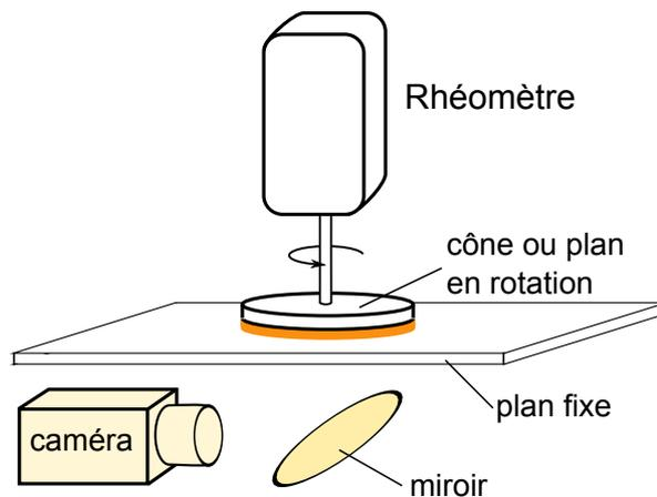
FIGURE 3.6 – Schéma du montage expérimental de cisaillement en rotation sous le rhéomètre
