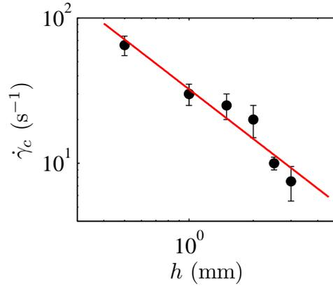
FIGURE 4.17 – Taux de cisaillement critique  $\dot{\gamma}_c$  en fonction du gap  $h$  dans le cas des suspensions de billes de verre à 4%. La droite est un ajustement par une loi de puissance  $\dot{\gamma}_c = B h^{-\beta}$  avec  $B = 32,33$  et  $\beta = 1,14$ .
