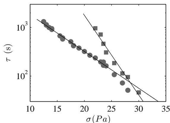
FIGURE 7.6 – Temps de fluidification  $\tau$  en fonction de la contrainte  $\sigma$  appliquée pour un gel de noir de carbone à 6% avec un précisaillement à  $+1000 \text{ s}^{-1}$  (protocole 4, ■) et à  $-1000 \text{ s}^{-1}$  (protocole 3, ●) en géométrie rugueuse.  $\tau$  est estimé à partir des mesures rhéologiques en considérant le point d'inflexion de  $\dot{\gamma}(t)$  en échelle linéaire
