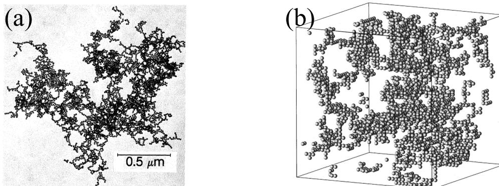
FIGURE 2.3 – (a) Photographie d’une suspension colloïdale de particules d’or prise au microscope confocal [Weitz et Oliveria, 1984] (b) Simulation numérique de DLCA à trois dimensions [Terao *et al.*, 1998]
