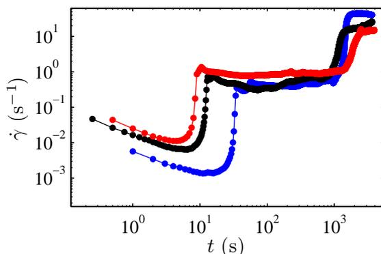
FIGURE 7.12 – Évolution du taux de cisaillement  $\dot{\gamma}$  en fonction du temps pour des gels de noir de carbone à différentes concentrations et pour différentes contraintes en géométrie rugueuse : 6% à 13 Pa (●) ; 8% à 45 Pa (●) et 10% à 90 Pa (●). Les contraintes ont été choisies pour donner un temps de rupture comparable dans les trois cas.
