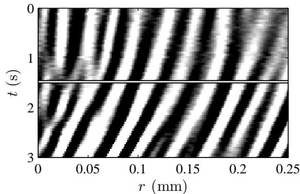
FIGURE 9.10 – Diagramme spatiotemporel du signal de pression  $p(r,t)$  reçu au cours du temps pour un gel de noir de carbone à 6% cisailé en géométrie rugueuse à  $0,14 \text{ s}^{-1}$ . La droite horizontale blanche correspond au temps au bout duquel la contrainte est maximale. L'expérience est la même que celle présentée sur la figure 9.9.
