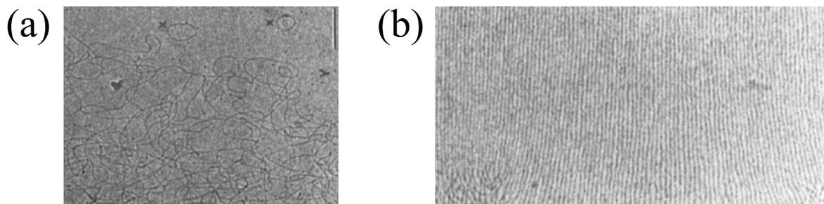
FIGURE 2.4 – Visualisation par cryo-TEM d'une solution de micelles cylindriques géantes (a) au repos et (b) après cisaillement [Clausen *et al.*, 1992]. La structure anisotrope induite par le cisaillement est très nettement visible sur la figure (b). La barre noir verticale en haut à droite de la figure (a) représente 100 nm.
