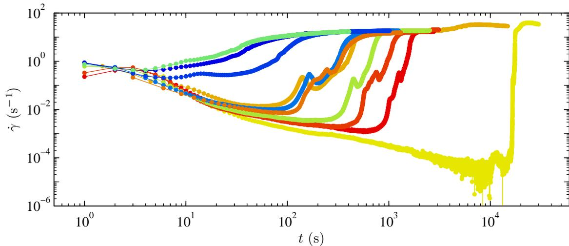
FIGURE 7.8 – Évolution du taux de cisaillement  $\dot{\gamma}$  en fonction du temps pour des gels de noir de carbone à 8% en géométrie lisse pour différentes contraintes. Les contraintes valent de droite à gauche : 45 ; 47 ; 50 ; 52 ; 53 ; 55 ; 60 ; 65 ; 70 et 75 Pa.
