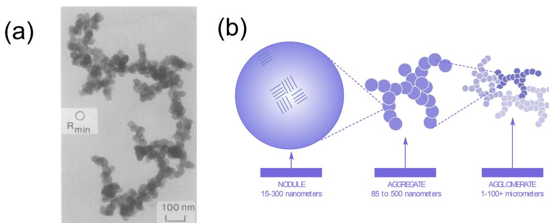
FIGURE 3.1 – (a) Image au microscope électronique d'un agrégat de noir de carbone (tirée de Ehrburger-Dolle *et al.* [1990] ). (b) Schéma illustrant la hiérarchie élément unique (ou « nodule ») - agrégat - agglomérat dans les gels de noir de carbone (tiré du guide de l'utilisateur de l'International Carbon Black Association, <http://www.carbon-black.org>).
