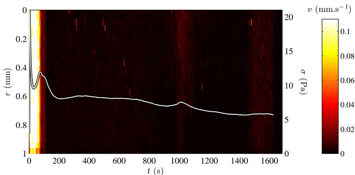
FIGURE 9.4 – Diagramme spatiotemporel du champ de vitesse  $v_\theta(r, t)$  au cours du temps dans un gel de noir de carbone à 6% cisailé en géométrie rugueuse à  $0,1 \text{ s}^{-1}$ . La courbe superposée au diagramme est la courbe de contrainte  $\sigma$  au cours du temps mesurée de façon simultanée.
