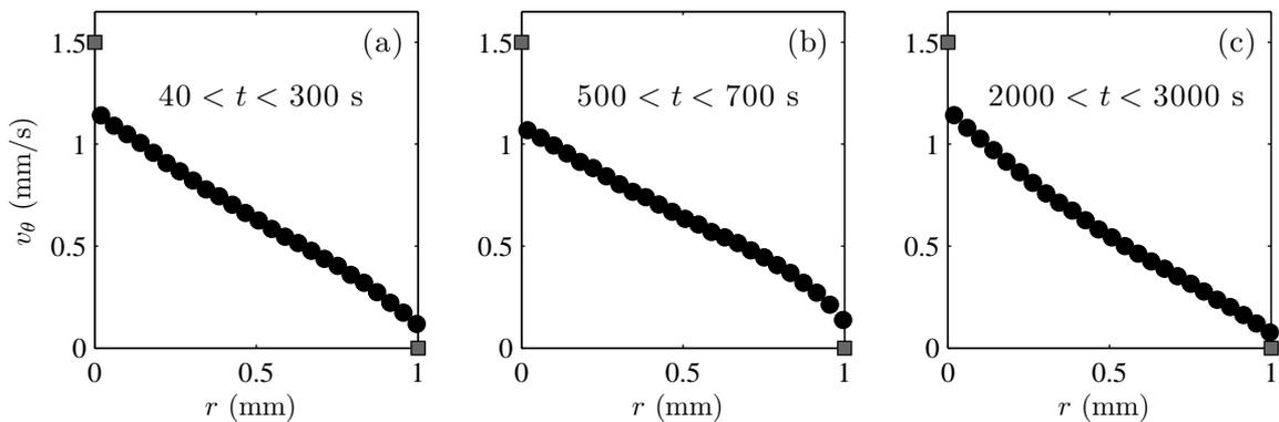
FIGURE 9.6 – Profils de vitesses moyennés sur les intervalles de temps indiqués pour un gel de noir de carbone cisailé à  $1,5 \text{ s}^{-1}$  en géométrie rugueuse. Les données correspondent à celles présentées sur la figure 9.5. La vitesse des parois (■) est indiquée au rotor ( $r = 0$  mm) et au stator ( $r = 1$  mm).
