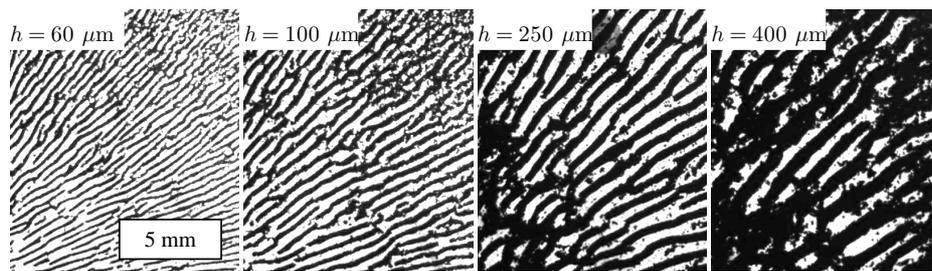
FIGURE 4.4 – Images de gels de noir de carbone structurés dans la géométrie plan-plan en rotation à différents gaps ( $h=60$ ;  $100$ ;  $250$  et  $400 \mu\text{m}$ ). Les taux de cisaillement sont respectivement  $15$ ;  $8$ ;  $2,2$  et  $1 \text{ s}^{-1}$ . L'échelle est la même pour toutes les images.
