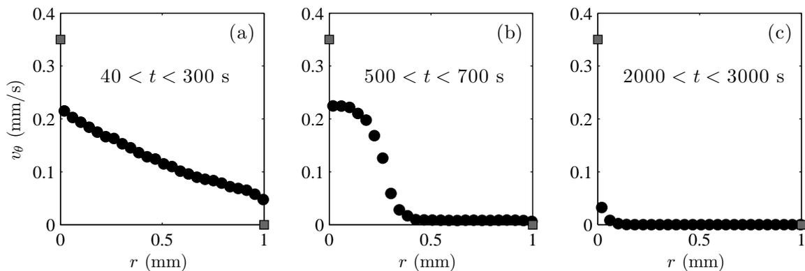
FIGURE 9.8 – Profils de vitesses moyennés sur les intervalles de temps indiqués pour un gel de noir de carbone cisailé à  $0,35 \text{ s}^{-1}$  en géométrie rugueuse. Les données correspondent à celles présentées sur la figure 9.7. La vitesse des parois (■) est indiquée au rotor ( $r = 0 \text{ mm}$ ) et au stator ( $r = 1 \text{ mm}$ ).
