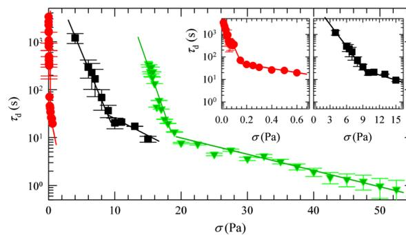
FIGURE 7.2 – Temps de fluidification en fonction de la contrainte imposée pour différents gels : gels de noir de carbone à 8% ( $\blacktriangledown$ ), suspension de particules de polystyrène rendues attractives par interaction de déplétion avec du dextran ( $\bullet$ ), gel thermoréversible à base de silice ( $\blacksquare$ ) [Sprakel *et al.*, 2011]. Les lignes en trait plein correspondent au modèle de rupture de liens détaillé dans [Lindström *et al.*, 2012].
