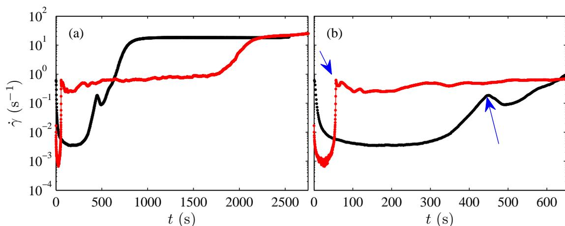
FIGURE 7.14 – Évolution au cours du temps du taux de cisaillement  $\dot{\gamma}$  pour un un gel de noir de carbone à 8% soumis à une contrainte constante de : 53 Pa en géométrie lisse ( $\bullet$ ) et 35 Pa en géométrie rugueuse ( $\bullet$ ). La figure (b) est un agrandissement de la figure (a) au début de l'expérience.
