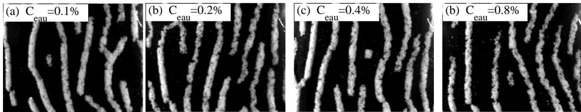
FIGURE 4.8 – Suspensions de billes de verre structurées à un taux de cisaillement  $\dot{\gamma} = 15$  s $^{-1}$  en géométrie de Couette avec un entrefer  $h = 1$  mm et une concentration en billes de verre  $C = 4\%$ . La concentration en eau  $C_{eau}$  vaut : (a) 0.1%; (b) 0.2%; (c) 0.4% et (d) 0.8% en masse. Les systèmes présentent une apparence très similaire.
