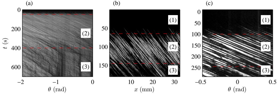
FIGURE 4.19 – Diagrammes spatiotemporels obtenus pour des gels de noir de carbone en (a) plan-plan en rotation ( $h = 100 \mu\text{m}$ ,  $C = 2\%$  et  $\dot{\gamma} = 2 \text{ s}^{-1}$ ); (b) plan-plan en translation ( $C = 2,5\%$  et  $\dot{\gamma} = 2 \text{ s}^{-1}$ ) et (c) cône-plan en rotation ( $C = 2\%$  et  $\dot{\gamma} = 0,5 \text{ s}^{-1}$ ).
