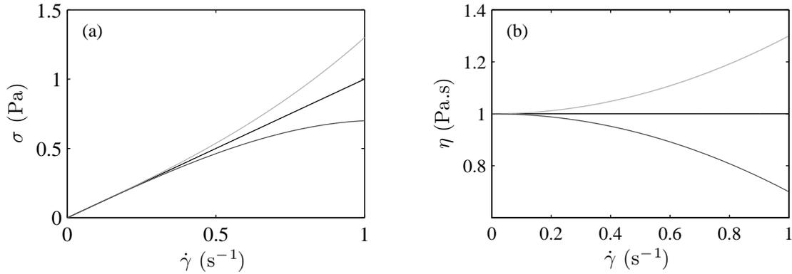
FIGURE 1.2 – Courbe d'écoulement pour un fluide newtonien (---), rhéofluidifiant (—) et rhéoépaississant (· · ·). (a) Contrainte  $\sigma$  en fonction du taux de cisaillement  $\dot{\gamma}$  et (b) viscosité  $\eta = \frac{\sigma}{\dot{\gamma}}$  en fonction du taux de cisaillement  $\dot{\gamma}$ .
