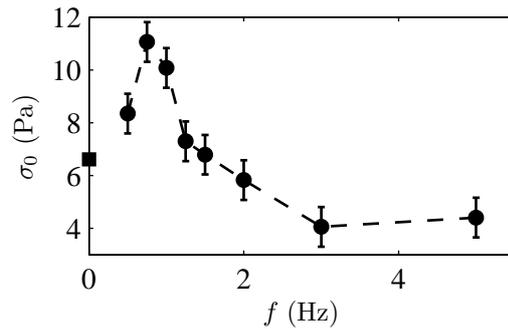
FIGURE 8.7 – Évolution de la contrainte  $\sigma_0$  définie sur la figure 8.6 en fonction de la fréquence de la contrainte appliquée en géométrie rugueuse. Le symbole (■) correspond à l'étude à contrainte constante, qui peut être vue comme l'extension à fréquence nulle.
