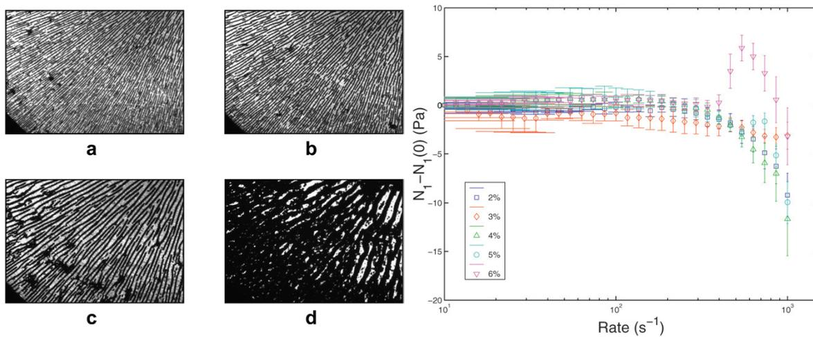
FIGURE 2.10 – Microstructure de gels de noir de carbone à 2% en masse cisailé à  $\dot{\gamma} = 10 \text{ s}^{-1}$  avec un gap de (a) 25  $\mu\text{m}$ ; (b) 50  $\mu\text{m}$ ; (c) 100  $\mu\text{m}$  et (d) 250  $\mu\text{m}$ . (e) Évolution de la première différence de contrainte normale (par rapport à la valeur de départ  $N_1(0)$ ) en fonction du taux de cisaillement [Osuji et Weitz, 2008].
