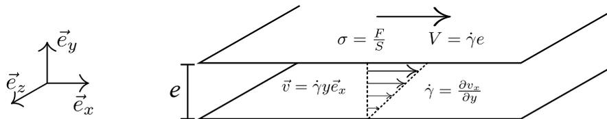
FIGURE 1.1 – Schéma d'un cisaillement simple entre deux plaques parallèles de surface  $S$  et écartées d'une distance  $e$ . La plaque supérieure est en mouvement à une vitesse  $V$  grâce à l'application d'une force  $\vec{F}$ . La contrainte appliquée au matériau est  $\sigma = F/S$  et le taux de cisaillement subi par le fluide est  $\dot{\gamma} = V/e$ .
