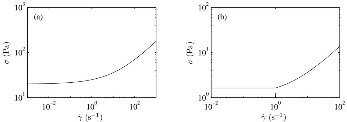
FIGURE 1.3 – (a) Courbe d'écoulement typique pour un fluide à seuil. La courbe tracée suit la loi d'Herschel-Bulkley :  $\sigma = \sigma_0 + k\dot{\gamma}^n$ . (b) Courbe d'écoulement en présence d'un taux de cisaillement critique  $\dot{\gamma}_c$  en dessous duquel le fluide ne s'écoule pas.
