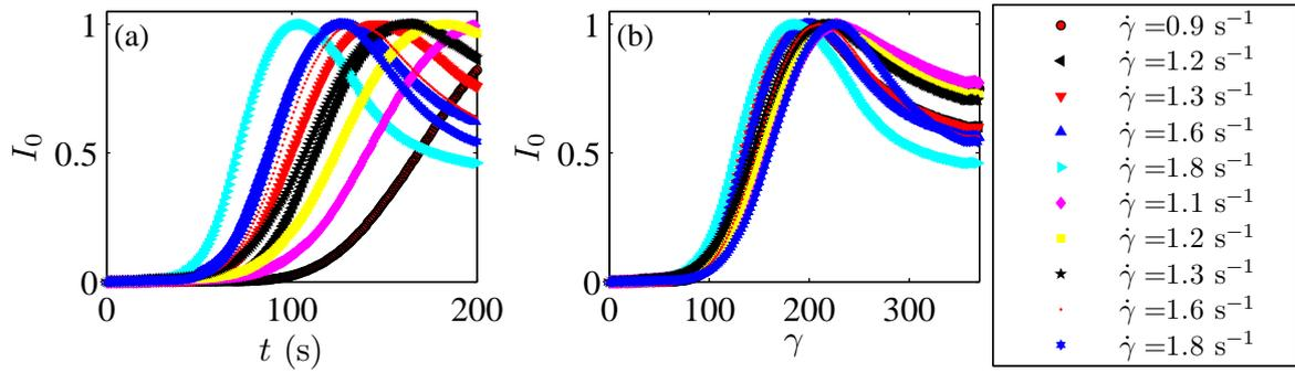
FIGURE 4.20 – Intensité lumineuse moyenne en fonction (a) du temps et (b) de la déformation pour des gels de noir de carbone de concentration  $C = 2,5\%$  à différents taux de cisaillement dans la cellule en translation. Le changement de variable  $t \rightarrow \gamma$  permet de superposer correctement les courbes.
