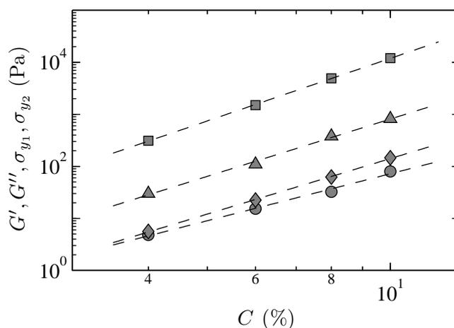
FIGURE 6.10 – Valeur du module élastique  $G'$  (■) et du module visqueux  $G''$  (▲) mesuré à 1 Hz et 2 Pa, de la contrainte seuil  $\sigma_{y_1}$  (●) estimée à partir du croisement de  $G'$  et  $G''$  à 1 Hz et la contrainte seuil  $\sigma_{y_2}$  (◆) estimée à partir de l'extrapolation de la courbe d'écoulement. Les courbes en pointillés correspondent à des ajustements par des lois de puissance d'exposants respectifs : 4 ; 3,7 ; 3 et 3,5.
