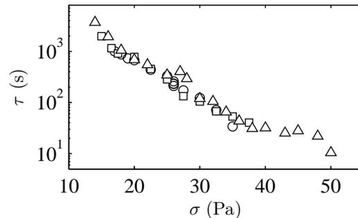
FIGURE 8.9 – Temps  $\tau$  de fluidification en fonction de l’amplitude de la contrainte  $\sigma$  pour un gel de noir de carbone à 6% à une fréquence  $f = 2$  Hz pour différentes conditions de rugosité des parois : stator et rotor lisses (o) ; stator lisse et rotor rugueux (□) et stator et rotor rugueux (△).
