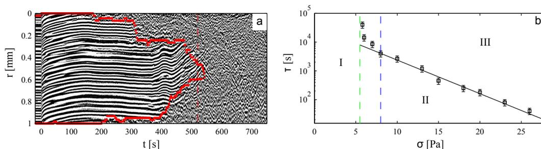
FIGURE 8.1 – Figures extraites de [Gibaud *et al.*, 2010]. (a) Diagramme spatiotemporel avec une fréquence d'échantillonnage égale à celle de l'oscillation de la contrainte. Les lignes rouges indiquent la zone solide dont la largeur décroît au cours du temps. (b) Temps de fluidification en fonction de l'amplitude de la contrainte oscillante à une fréquence de 1 Hz.
