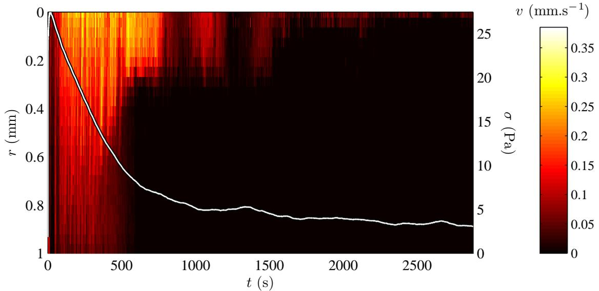
FIGURE 9.7 – Diagramme spatiotemporel du champ de vitesse  $v_{\theta}(r, t)$  au cours du temps dans un gel de noir de carbone à 6% cisailé en géométrie rugueuse à  $0,35 \text{ s}^{-1}$ . La courbe superposée au diagramme est la courbe de contrainte  $\sigma$  au cours du temps.
