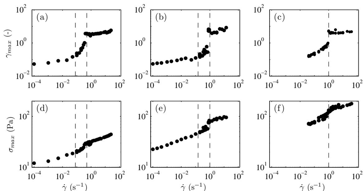
FIGURE 9.3 – Évolution de la déformation  $\gamma_{max}$  (a–c) et de la contrainte  $\sigma_{max}$  en fonction du taux de cisaillement  $\dot{\gamma}$  en géométrie rugueuse à différentes concentrations : (a,d) 6% ; (b,e) 8% et (c,f) 10%. Dans le cas du gel à 10%, la gamme correspondant à la transition n'est pas évidente à distinguer. Seules les données correspondant au premier maximum de  $\sigma(t)$  sont reportées.
