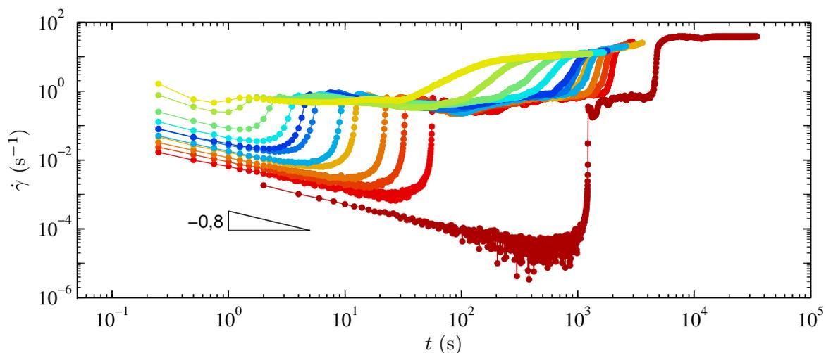
FIGURE 7.9 – Évolution du taux de cisaillement  $\dot{\gamma}$  en fonction du temps pour des gels de noir de carbone à 8% en géométrie rugueuse pour différentes contraintes. Les contraintes valent de droite à gauche : 27 ; 35 ; 38 ; 41 ; 45 ; 47 ; 50 ; 52 ; 55 ; 60 ; 70 et 80 Pa.
