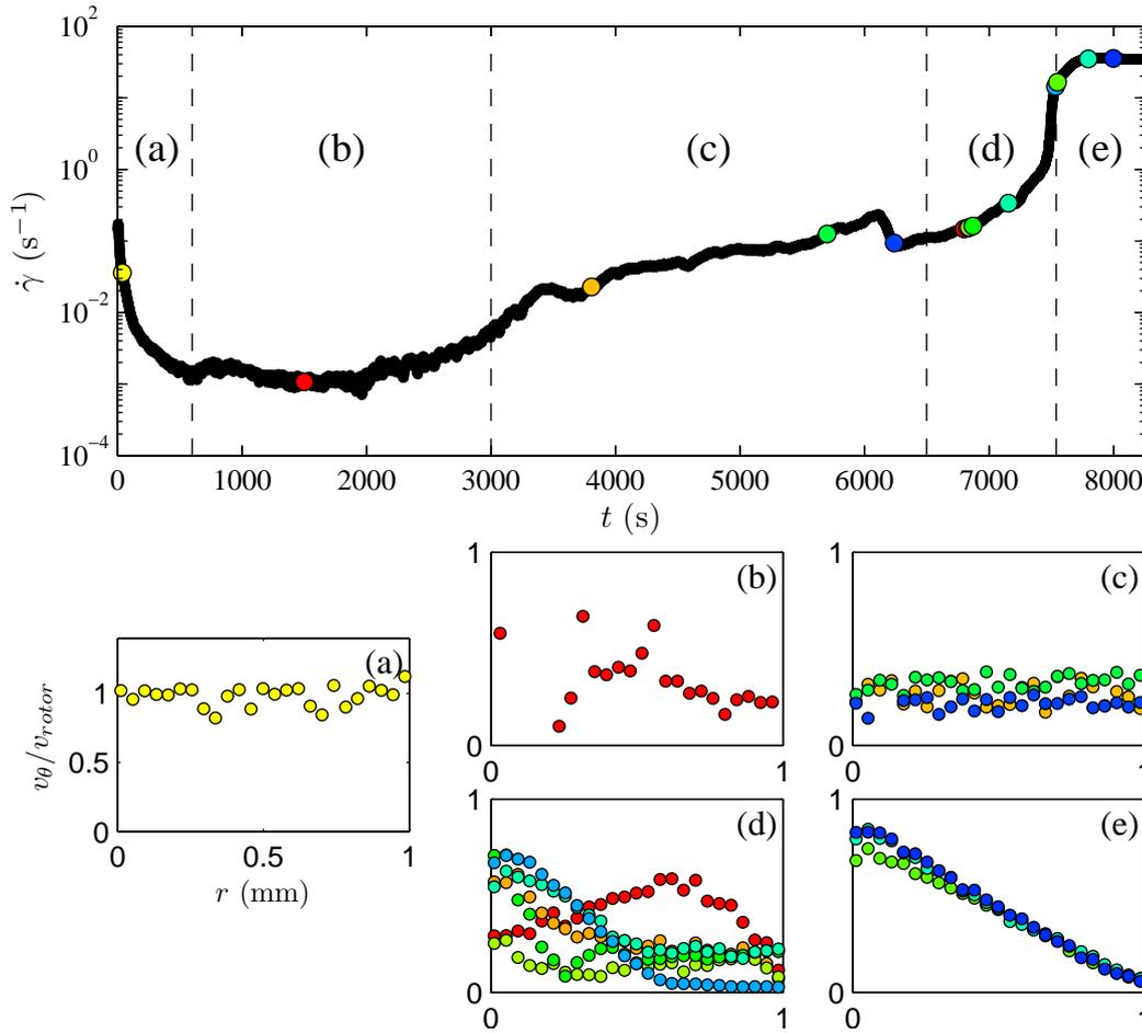
FIGURE 7.11 – Taux de cisaillement  $\dot{\gamma}$  en fonction du temps  $t$  pour un gel de noir de carbone à 6% soumis à une contrainte de cisaillement de 16 Pa en géométrie lisse. Les pointillés séparent 5 zones (a–e) pour lesquelles des profils de vitesse typiques sont tracés à droite. (a) glissement total au stator, (b) profil bouchon (?), glissement au rotor et au stator, (c) profil bouchon bien résolu, (d) fortes oscillations du profil de vitesse, (e) profils linéaires.
