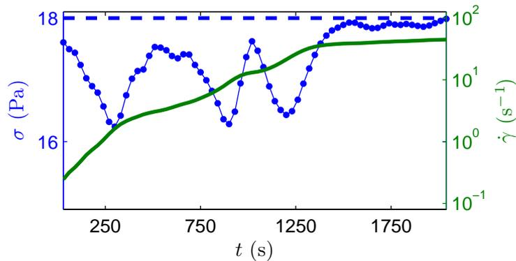
FIGURE 8.2 – Évolution de la contrainte (courbe bleue) et de la déformation lors d'une expérience à 0.2 Hz dans un gel de noir de carbone à 6%. L'amplitude de la contrainte que le rhéomètre doit appliquer est 18 Pa (en pointillés).
