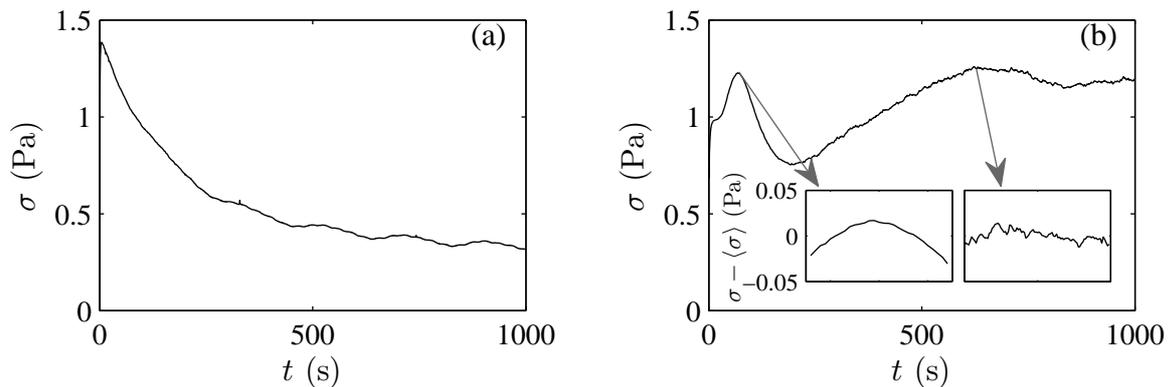
FIGURE 3.12 – Exemples de courbes de contrainte au cours du temps pour des expériences sur le noir de carbone à 2% en géométrie plan-plan en rotation à taux de cisaillement imposé. (a)  $h=500 \mu\text{m}$ ;  $\dot{\gamma} = 2 \text{ s}^{-1}$ ; ne forme pas de structures. (b)  $h=150 \mu\text{m}$ ;  $\dot{\gamma} = 0,5 \text{ s}^{-1}$ ; forme des rouleaux. Les inserts de la figure (b) montrent des agrandissements de la contrainte au début et à la fin de l'expérience (sur 20 puis 100 s).
