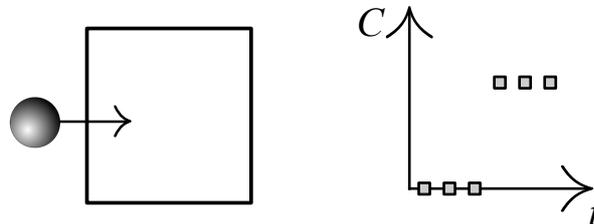
FIGURE A.3 – Évolution de la compacité calculée en un point dans le cas où la moyenne est réalisée de façon naïve. La compacité passe brutalement de 0 à sa valeur finale. La valeur de la dérivée  $\partial_t \epsilon$  calculée numériquement dépend donc très fortement du pas de temps choisi.
