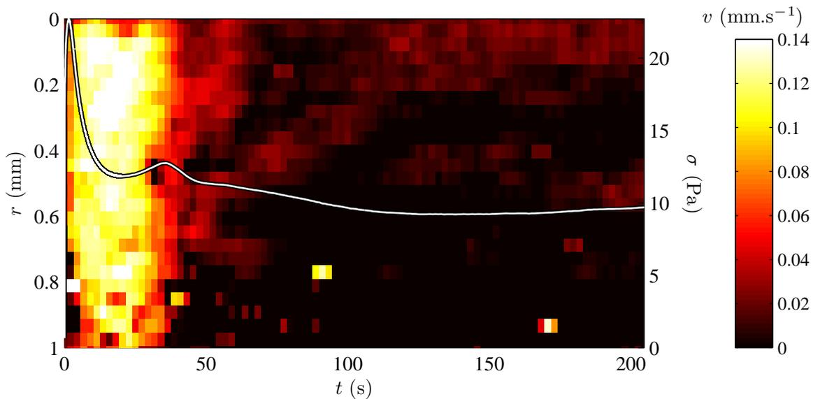
FIGURE 9.9 – Diagramme spatiotemporel du champ de vitesse  $v_{\theta}(r, t)$  au cours du temps dans un gel de noir de carbone à 6% cisailé en géométrie rugueuse à  $0,14 \text{ s}^{-1}$ . La courbe superposée au diagramme est la courbe de contrainte  $\sigma$  au cours du temps. Les données sont plus bruitées que sur les figures précédentes car elles ont été moyennées sur un moins grand nombre d'impulsions ultrasonores afin d'améliorer la résolution temporelle.
