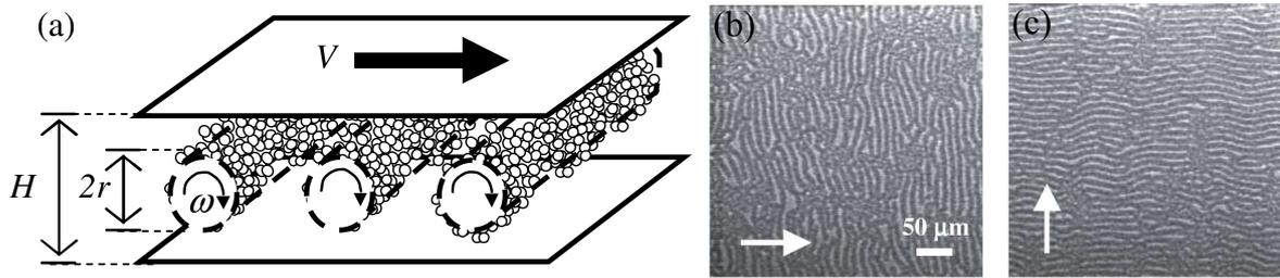
FIGURE 2.8 – (a) Schéma des structures alignées selon la vorticité dans une émulsion d’eau dans de l’huile. (b-c) Images obtenues après cisaillement pour une hauteur de confinement de  $12\ \mu\text{m}$  [Montesi *et al.*, 2004].
