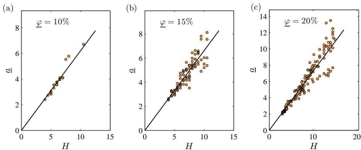
FIGURE 5.12 – Taille des rouleaux  $a$  en fonction de la hauteur de confinement  $H$  pour trois fractions volumiques  $\varphi$  : (a) 10, (b) 15, et (c) 20%. Les droites sont des ajustements linéaires de pente (a) 0,62 ; (b) 0,66 ; (c) 0,73.
