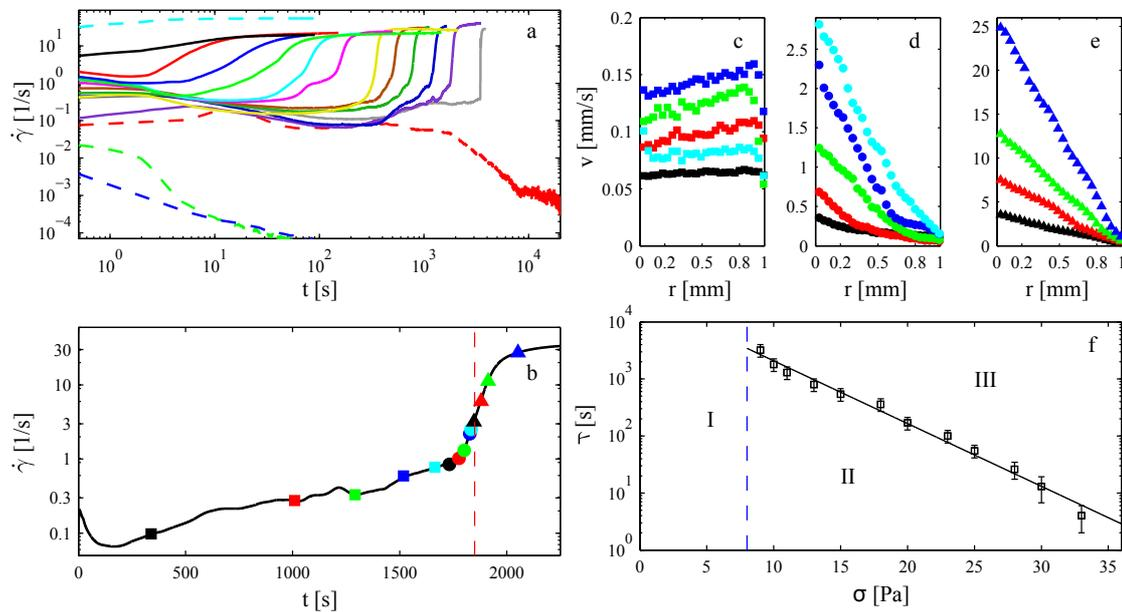
FIGURE 7.4 – Figure extraite de [Gibaud *et al.*, 2010]. Le gel étudié est un gel de noir de carbone à 6%. (a) Évolution du taux de cisaillement en fonction du temps pour différentes contraintes appliquées. (b-e) Évolution au cours du temps du taux de cisaillement et des profils de vitesse pour une contrainte imposée de 10 Pa. Le temps de fluidification est indiqué par la droite rouge en pointillés sur la figure (b). (f) Temps de fluidification en fonction de la contrainte appliquée.
