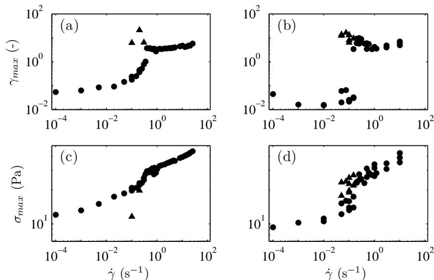
FIGURE 9.11 – Évolution de la déformation  $\gamma_{max}$  (a–b) et de la contrainte  $\sigma_{max}$  (b–d) en fonction du taux de cisaillement  $\dot{\gamma}$  en géométrie rugueuse (a,c) et lisse (b,d) pour un gel de carbone à 6% en masse.
