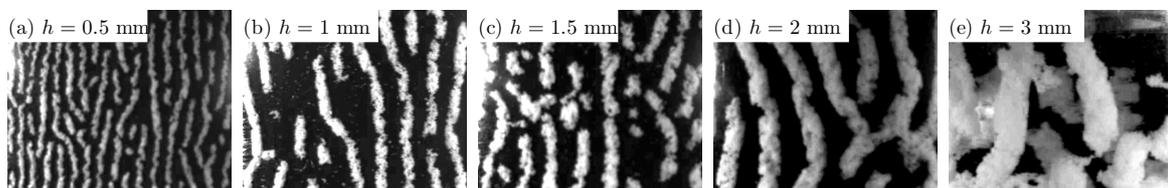
FIGURE 4.6 – Rouleaux obtenus en géométrie de Couette dans des suspensions de billes de verre. La concentration est  $C = 4\%$  en masse et les gaps sont : (a)  $0,5$ ; (b)  $1$ ; (c)  $1,5$ ; (d)  $2$  et (e)  $3 \text{ mm}$ . L'image (e) a été obtenue avec un rotor qui n'avait pas été peint en noir : les structures de l'autre côté du Couette sont donc visibles à l'arrière-plan.
