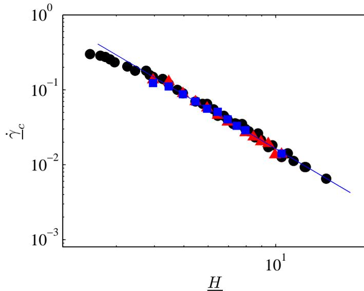
FIGURE 5.17 – Taux de cisaillement critique  $\dot{\gamma}_c$  en fonction de la hauteur  $H$  pour différentes fractions volumiques  $\varphi$  : 10% (■), 15% (▲), 20% (●). La ligne bleue est un ajustement des données obtenues pour  $H > 3.2$  par une loi de puissance  $\dot{\gamma} = \alpha H^\beta$  avec un exposant  $\beta = -2.4$  et un préfacteur  $\alpha = 4.1$ .
