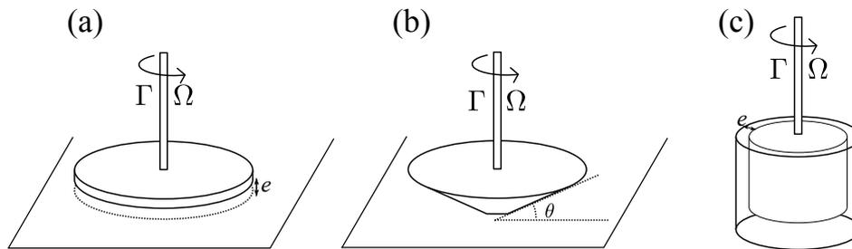
FIGURE 1.5 – Géométries classiques pour un rhéomètre rotatif : (a) géométrie plan-plan, (b) géométrie cône-plan et (c) géométrie de Couette. Le rhéomètre impose un couple  $\Gamma$  ou une vitesse de rotation  $\Omega$  à l'axe de rotation.
