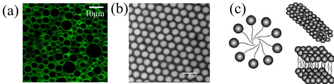
FIGURE 2.1 – (a) Photographie au microscope confocal d'émulsions de dodécane dans un mélange eau-glycérol [Weeks, 2007]. (b) Photographie au microscope confocal de suspensions concentrées de PMMA [Weeks, 2007]. (c) Schéma de l'organisation de molécules tensioactives à différentes concentrations [Tognisso, 2011]. Ces trois images illustrent la présence d'une microstructure<sup>1</sup>.
