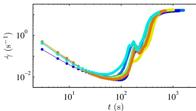
FIGURE 7.7 – Taux de cisaillement  $\dot{\gamma}$  en fonction du temps pour un gel de noir de carbone à 8% soumis à une contrainte de 60 Pa en géométrie lisse. Les différentes courbes correspondent à six réalisations différentes de l'expérience dans les mêmes conditions expérimentales et sur le même échantillon. Elles permettent d'estimer la dispersion des résultats.
