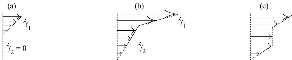
FIGURE 1.6 – Exemples d'écoulements présentant des bandes de cisaillement. (a) Une partie du fluide est arrêtée et une autre partie est cisailée. (b) L'ensemble du fluide est cisailé, mais à deux taux de cisaillement distincts. (c) Le fluide présente une région non cisailée au milieu et deux régions cisailées sur les bords. Le taux de cisaillement local  $\dot{\gamma} = \frac{\partial v_x}{\partial y}$  correspond à la « pente » locale du profil de vitesse.
