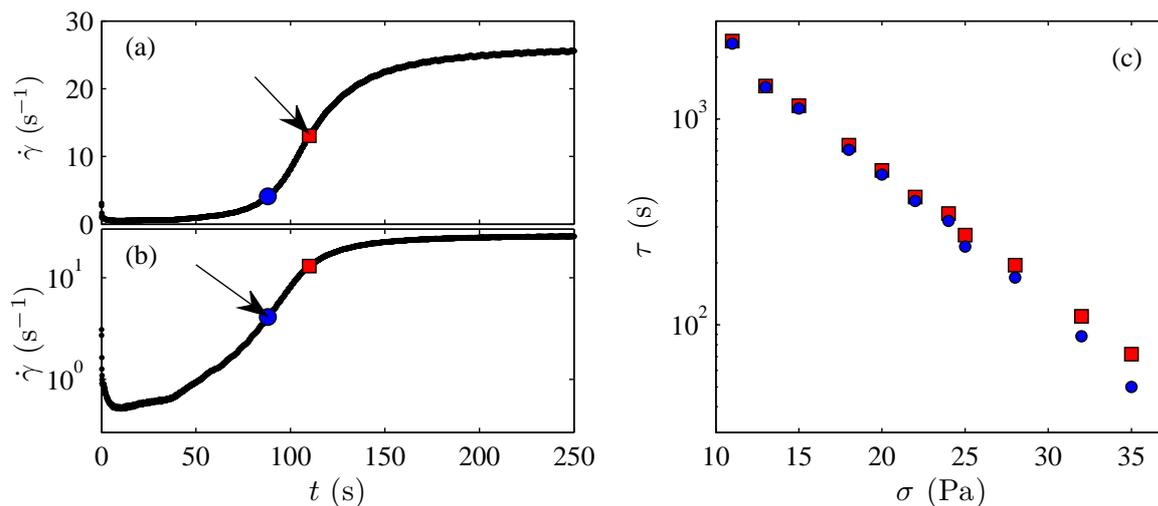
FIGURE 7.5 – Exemple d'évolution du taux de cisaillement  $\dot{\gamma}$  en fonction du temps en échelle linéaire (a) et semi-logarithmique (b). (■) indique la position du point d'inflexion sur la courbe en échelle linéaire et (●) sur la courbe en échelle semi-logarithmique. (c) Évolution en fonction de la contrainte des temps de fluidification mesurés des deux façons (■) en linéaire et (●) en semi-logarithmique).
