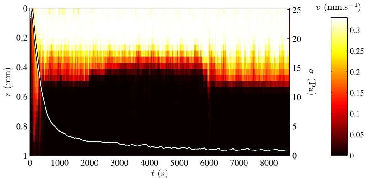
FIGURE 9.12 – Diagramme spatiotemporel du champ de vitesse  $v_{\theta}(r, t)$  au cours du temps dans un gel de noir de carbone à 6% cisailé en géométrie lisse à  $0,3 \text{ s}^{-1}$ . La courbe superposée au diagramme est la courbe de contrainte  $\sigma$  au cours du temps.
