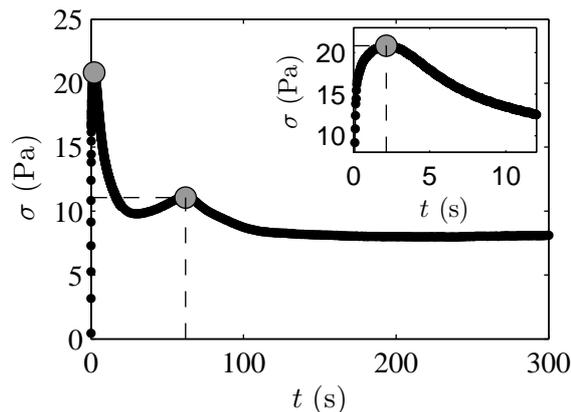
FIGURE 9.1 – Contrainte nécessaire pour appliquer un taux de cisaillement de  $0,1 \text{ s}^{-1}$  à un échantillon de noir de carbone de concentration  $C = 6\%$  en géométrie de Couette rugueuse. L'insert est un agrandissement sur le début de la courbe. On observe deux maxima locaux indiqués par des points gris.
