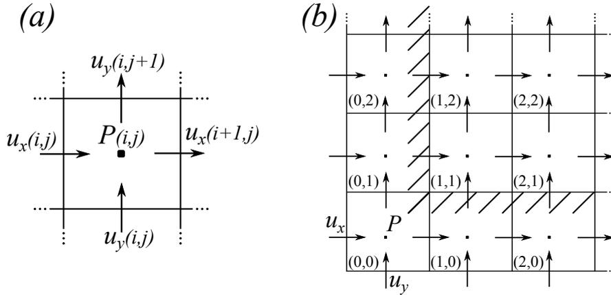
FIGURE A.2 – Schéma de la méthode de discrétisation utilisée. (a) Agrandissement au niveau de la cellule indexée par  $i$  et par  $j$ . (b) Coin en bas à gauche du domaine modélisé. La limite du domaine physique est indiquée par les hachures : les points indexés par  $i = 0$  ou  $j = 0$  sont donc des points en dehors du domaine physique.
