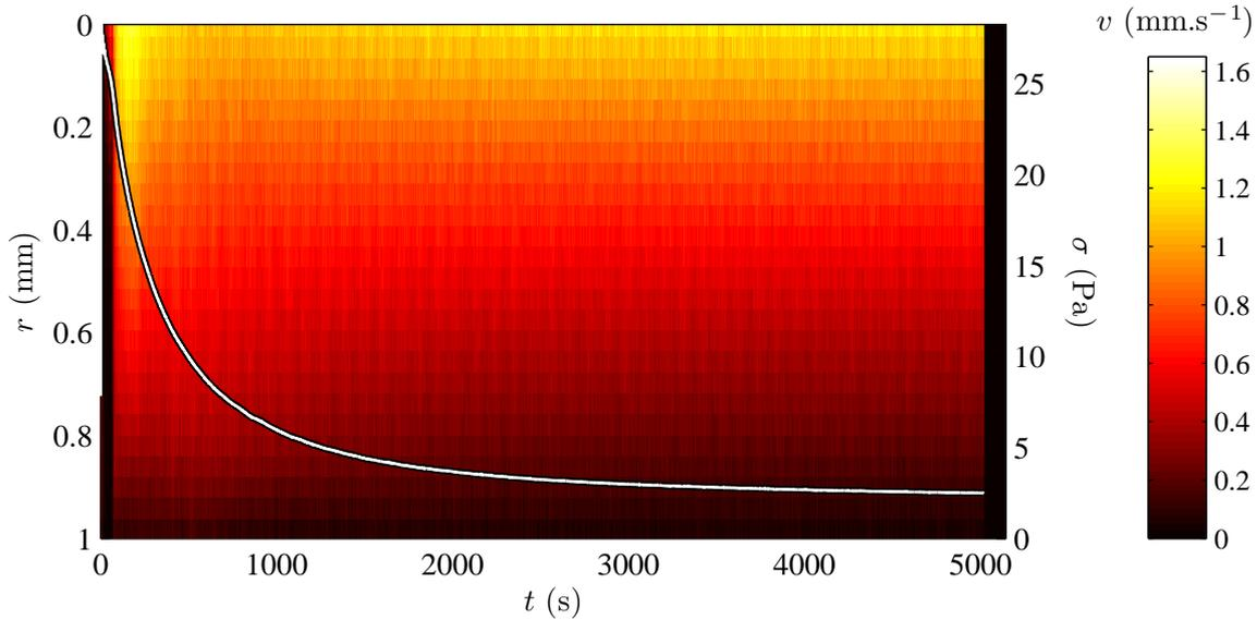
FIGURE 9.5 – Diagramme spatiotemporel du champ de vitesse  $v_\theta(r, t)$  au cours du temps dans un gel de noir de carbone à 6% cisailé en géométrie rugueuse à  $1,5 \text{ s}^{-1}$ . La courbe superposée au diagramme est la courbe de contrainte  $\sigma$  au cours du temps.
