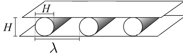
FIGURE 5.14 – Schéma représentant la forme approximative des rouleaux : des cylindres de diamètre  $H$  repartis régulièrement avec une périodicité  $\lambda$ . Ainsi, la conservation du volume des particules implique que  $\lambda H \varphi_i = \pi(H^2/4)\varphi_r$  où  $\varphi_i$  est la fraction volumique à l'état initial lorsque les particules sont réparties de façon homogène et  $\varphi_c$  est la fraction volumique des particules dans les structures.
