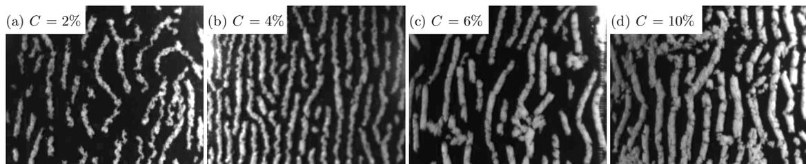
FIGURE 4.5 – Rouleaux obtenus en géométrie de Couette dans des suspensions de billes de verre. Le gap est  $h = 0,5 \text{ mm}$  et les concentrations sont : (a)  $2$ ; (b)  $4$ ; (c)  $6$  et (d)  $10\%$  en masse.
