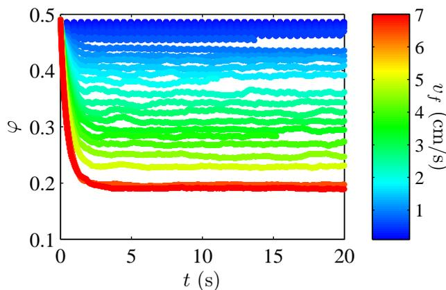
FIGURE A.6 – Évolution de la fraction volumique  $\phi$  au cours du temps pour différentes vitesses  $v_f$  imposées en bas du domaine.
