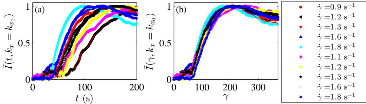
FIGURE 4.21 – Intensité de la transformée de Fourier en  $k_x = 1/\lambda$  en fonction (a) du temps et (b) de la déformation pour des gels de noir de carbone de concentration  $C = 2,5\%$  à différents taux de cisaillement dans la cellule en translation. Le changement de variable  $t \rightarrow \gamma$  permet de superposer correctement les courbes.
