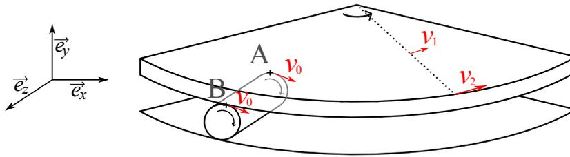
FIGURE 4.15 – Schéma illustrant l'incompatibilité géométrique entre les rouleaux et un cisaillement en rotation plan-plan. Le rouleau étant en rotation solide autour de l'axe  $z$ , il a la même vitesse au point A et au point B. À l'inverse, le plan supérieur est en rotation solide autour de l'axe  $y$  et sa vitesse  $v_1$  en A est inférieure à la vitesse  $v_2$  en B. Les structures se fragmentent donc en rouleaux de plus en plus courts.
