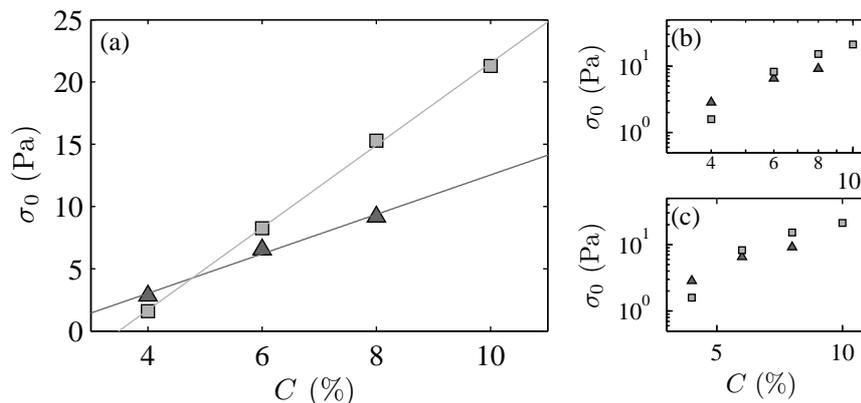
FIGURE 8.11 – Évolution du paramètre  $\sigma_0$  à une fréquence de 1 Hz avec la concentration en géométrie rugueuse (■) et lisse (▲) en coordonnées (a) linéaires, (b) logarithmiques et (c) semi-logarithmiques. Les droites sont des ajustements linéaires d'équations  $\sigma_0 = 3,3 \times C - 12$  dans le cas rugueux et  $\sigma_0 = 1,6 \times C - 3,3$  dans le cas lisse.
