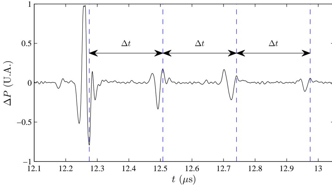
FIGURE 3.5 – Signal de pression  $\Delta P$  reçu au cours du temps lors d’une mesure effectuée grâce au montage présenté figure 3.4. L’intervalle de temps  $\Delta t$  présenté sur la figure correspond au temps de propagation de l’onde ultrasonore pour faire un aller-retour dans l’échantillon de noir de carbone. Le premier écho est en opposition de phase avec les suivants.
