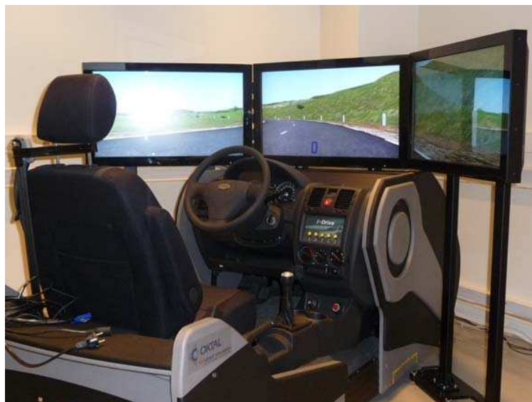
Figure 3.10. Simulateur à base fixe SCANeR™
