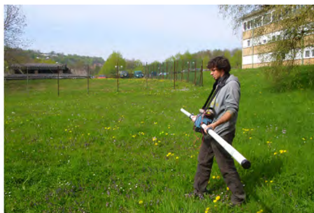
Figure 34. Vue de l'appareil EM31-MK2, avec le GPS, le système Allegro et le DataLogger, à gauche. Vue de l'appareil en fonctionnement, à droite (Photographies : C. Laplaige)
