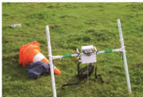
Grad 601-2 Dual gradiometer de Bartington
