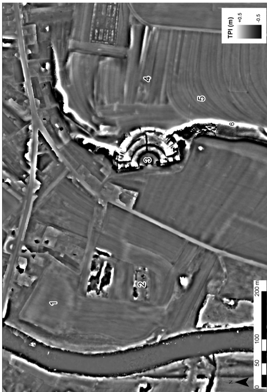
Figure 71. Exemple d'un MNT traité avec la fonction TPI (indice de position topographique)(C. Laplaige, 2011)
