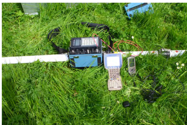
Figure 34. Vue de l'appareil EM31-MK2, avec le GPS, le système Allegro et le DataLogger, à gauche. Vue de l'appareil en fonctionnement, à droite (Photographies : C. Laplaige)
