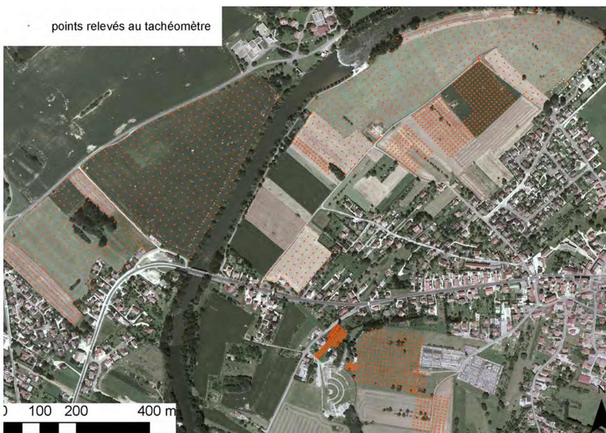
Figure 44. Mandeuire-Mathay (Doubs). Maillage des points microtopographiques relevés au tachéomètre (C. Laplaige, 2011)
