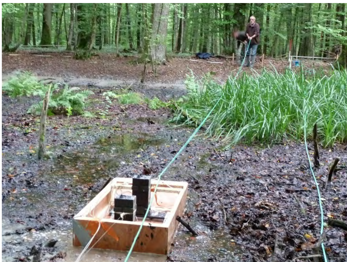
Figure 38. Dolving (Moselle). Prospection radar de la mardelle de Kholjungswald. Les antennes, embarquées sur la barque ATKEITL sont déplacées grâce à un système de câble (cliché: J-P.Simonnet, 2010)
