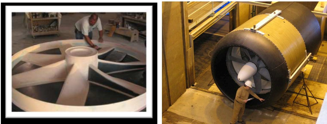
FIGURE I.20 – Turbines utilisées pour le projet FFP
