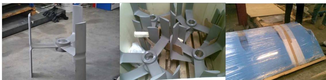
FIGURE IV.7 – Eléments de l'hydrolienne (turbines, carénages)
