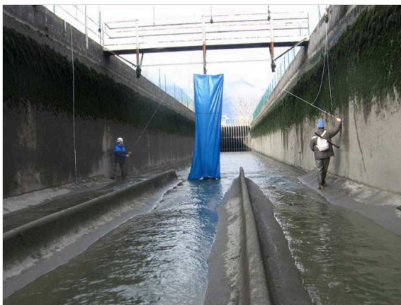
FIGURE IV.2 – Canal vidangé et simulation emplacement hydrolienne
