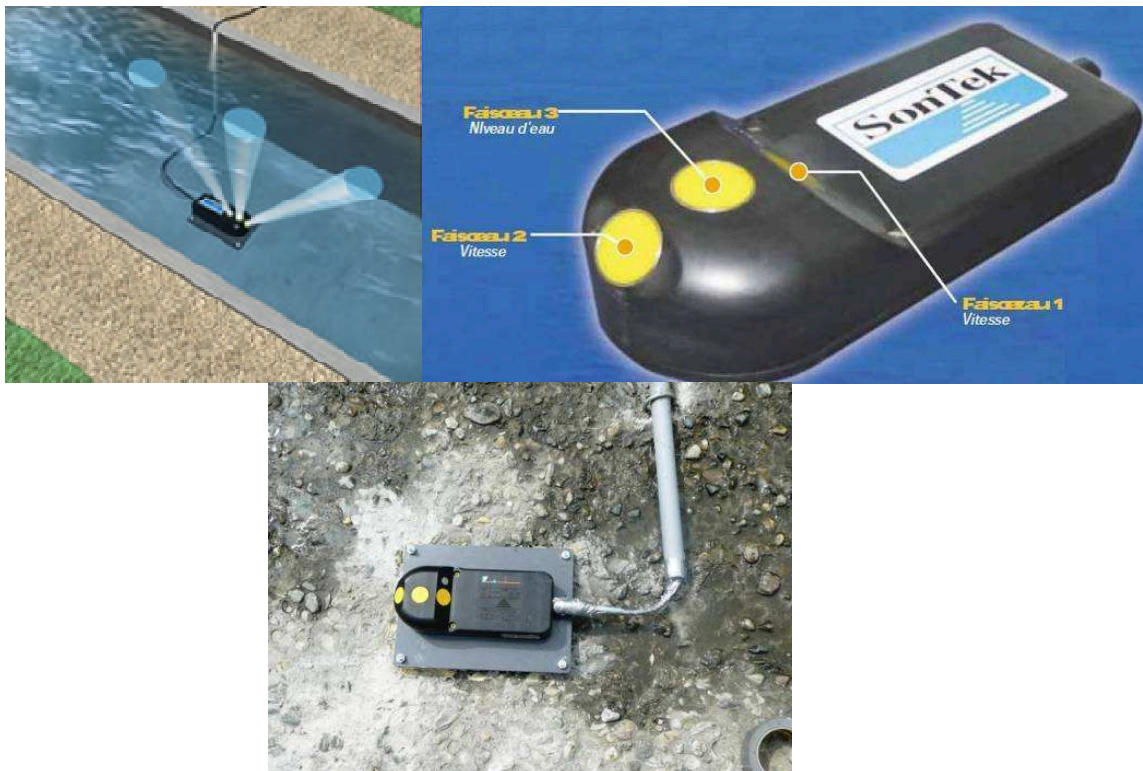
FIGURE IV.24 – Capteur Doppler 2D utilisé pour relever la vitesse de l'eau
