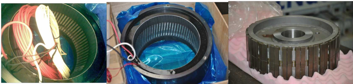
FIGURE IV.9 – Génératrices, stator et rotor
