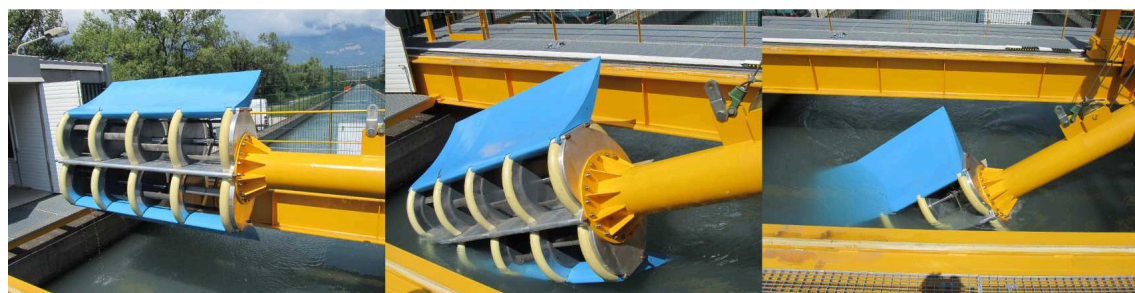
FIGURE IV.23 – Cinématique de mise à l'eau de l'hydrolienne
