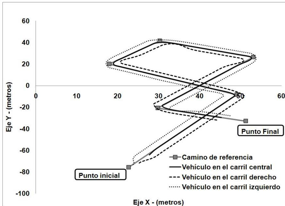
Figura 5.37: Cambios de carril utilizando el controlador proporcional multivariable
