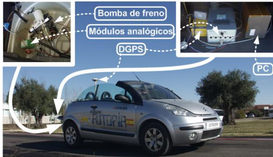
Figura 4.1: Clavileño con los dispositivos y actuadores embarcados
