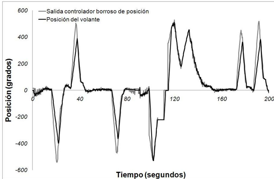
Figura 5.33: Salida del controlador y posición del volante en el experimento 5.31
