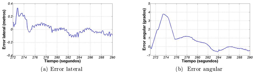
Figura 5.60: Variables de control experimento 2, cambio de carril
