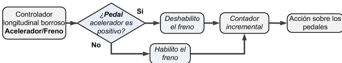
Figura 4.2: Estructura del control longitudinal con función incremental
