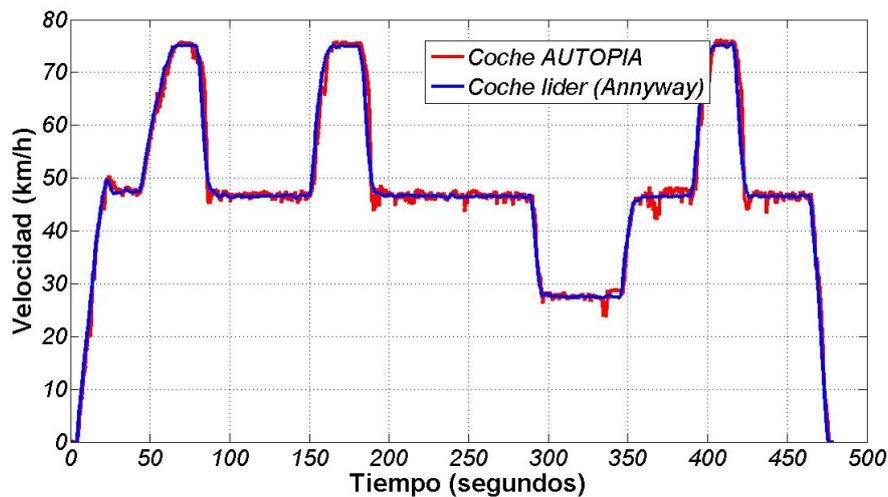
Figura 5.69: Experimento 1: Velocidades del vehículo líder -Annyway- y el seguidor -AUTOPIA-
