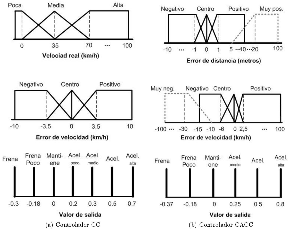
Figura 5.67: Funciones de pertenencia del CC y CACC por en el GCDC 2011
