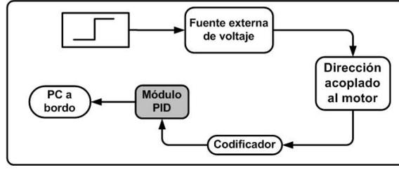
Figura 3.6: Estimación del sistema en lazo abierto
