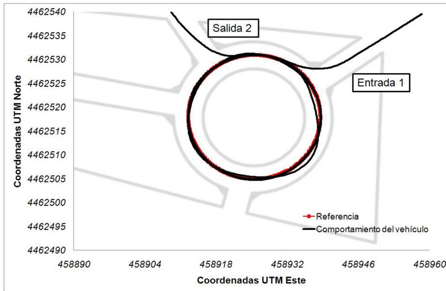
Figura 5.47: Comportamiento del sistema a diferentes velocidades, circulado por el carril central de la rotonda
