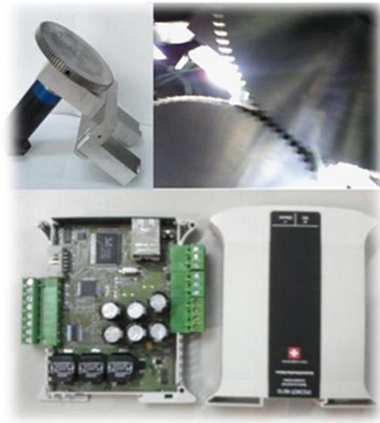
Figura 3.2: Motor, relación de engranajes y controlador
