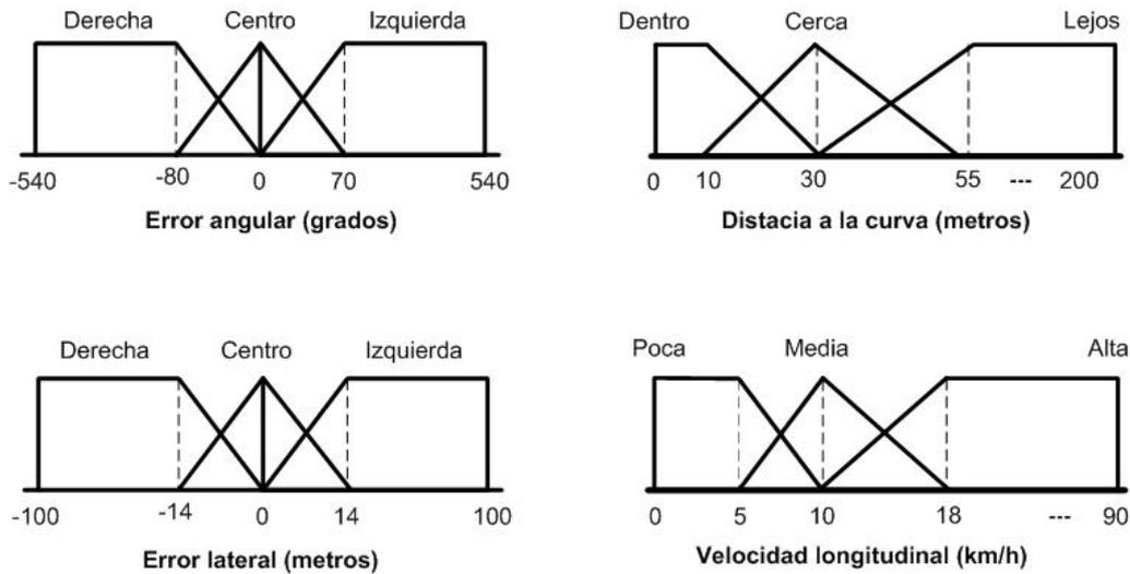
Figura 3.10: Funciones de pertenencia para el control del volante
