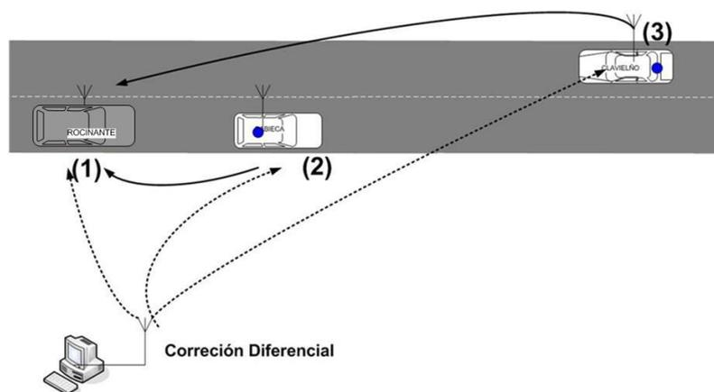
Figura 5.3: Comunicación entre vehículos y corrección diferencial
