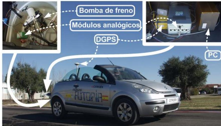
Figura 4.1: *Clavileño* con los dispositivos y actuadores embarcados
