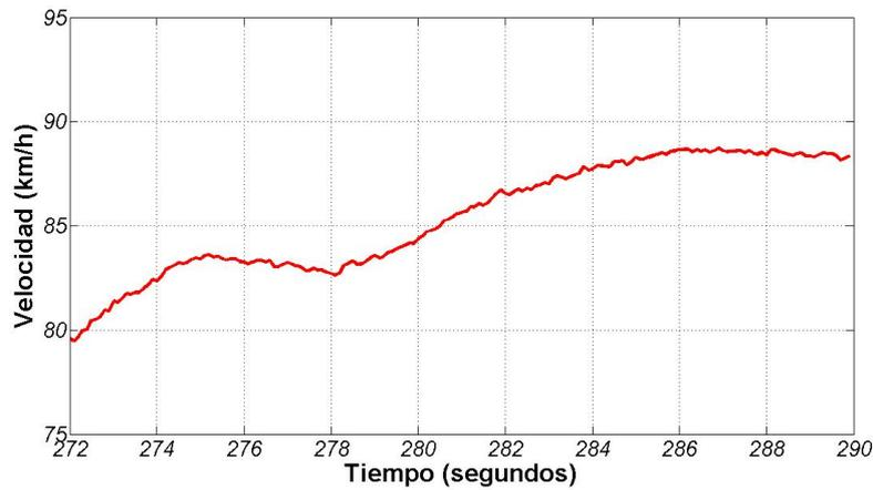
Figura 5.59: Velocidad del vehículo con dirección autónoma en el experimento 2, cambio de carril
