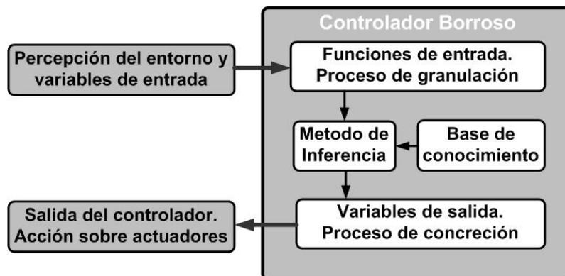
Figura 2.12: Esquema de funcionamiento de un controlador borroso
