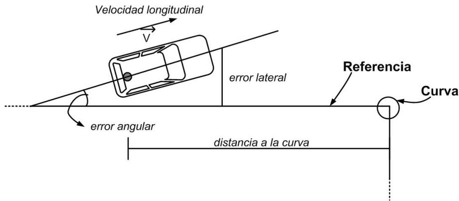
Figura 3.9: Variables de entrada del controlador borroso
