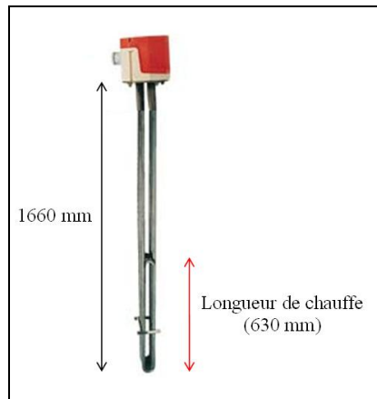
Figure 74 Thermoplongeur destiné à chauffer la cuve chaude
