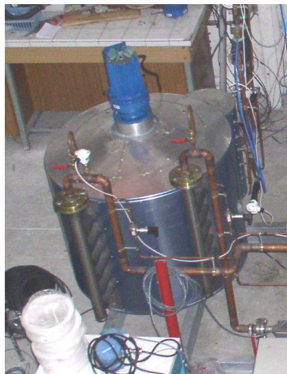
Figure 59 Le générateur d'hydrates
