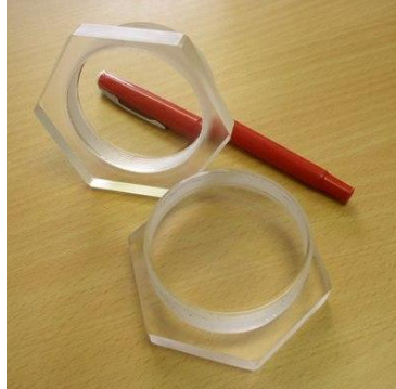
Figure 60 Ecrous transparents des étages du générateur
