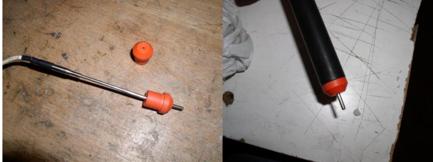
Figure 73 Montage des sondes de température de la cuve chaude
