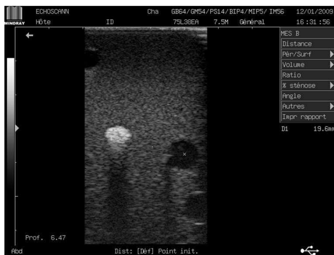
FIGURE C.2 – Échographie à 7.5 MHz du fantôme mammaire CIRS
