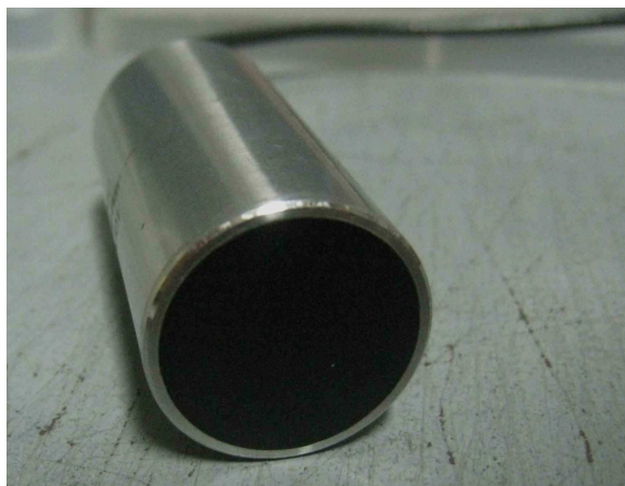
FIGURE B.2 – L’un des deux transducteurs circulaires plans de fréquence centrale 3 MHz et de diamètre 14 mm.
