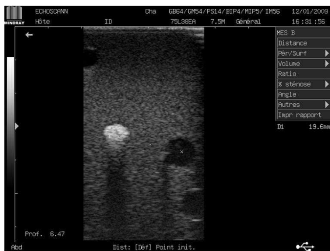
FIGURE C.2 – Échographie à 7.5 MHz du fantôme mammaire CIRS
