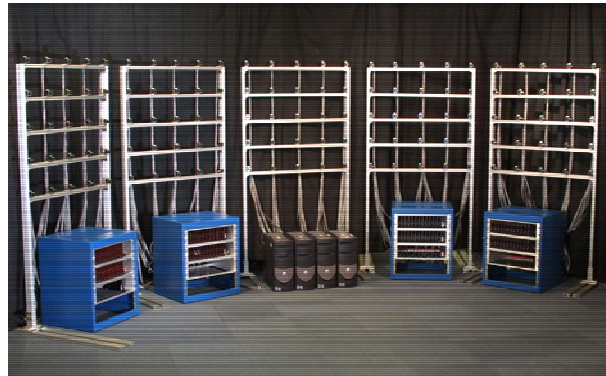
Figure 60 : mur de caméras (Stanford Camera Array)
