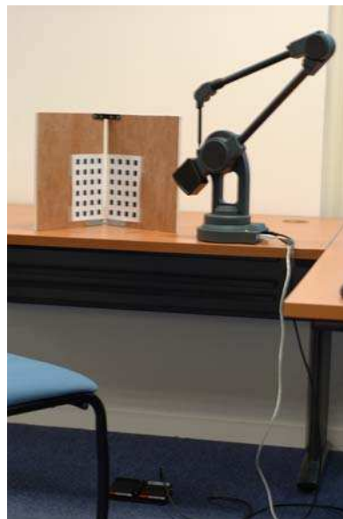
Figure 83 : les points caractéristiques de la mire sont localisés à l'aide d'un bras articulé.
