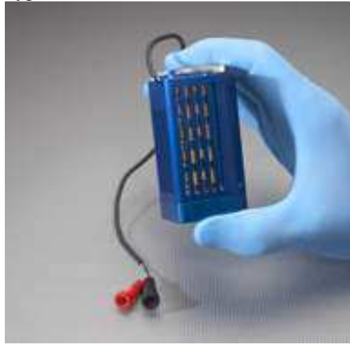
Figure I-16: Système de recharge \mu PEMFC à H_2 /Air CEA Liten (2008) [LIw]
