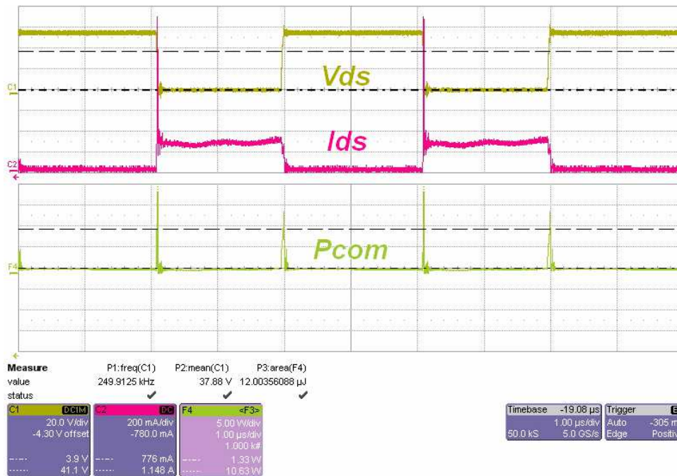
figure 47: Grandeurs significatives et image des pertes par commutation du convertisseur abaisseur de tension réalisé durant une période de commutation à la fréquence de 250kHz
