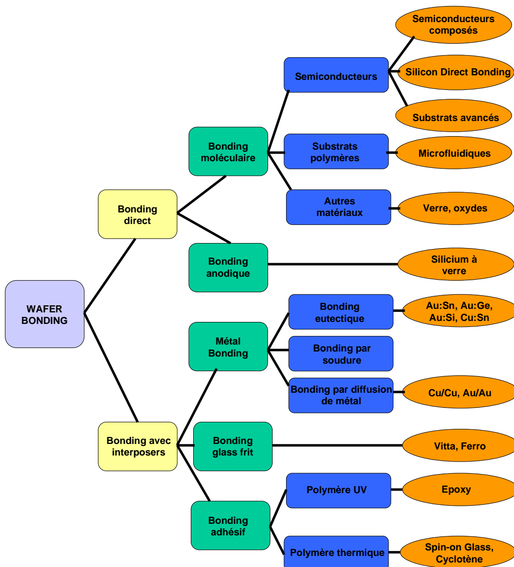
figure 48: Résumé des différentes méthodes de bonding à l'échelle du wafer
