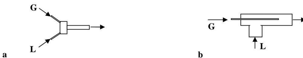
**Figure III-3 : Représentation schématique des deux systèmes de mélange gaz (G)/liquide (L) étudiés : *a* -  $\mu$ -mélangeur ; *b* – coaxial.**
