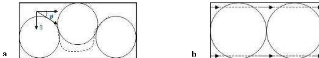
**Figure III-47 : Représentation schématique l'empilement des particules et des lignes de courant principales (lignes en pointillée) dans la configuration R3 (a) et R4 (b) – vue de côté. Dans la figure a, g représente la force gravitaire et  $\theta$  l'angle d'inclinaison de l'écoulement pour pouvoir contourner les particules que bloquent le passage.**
