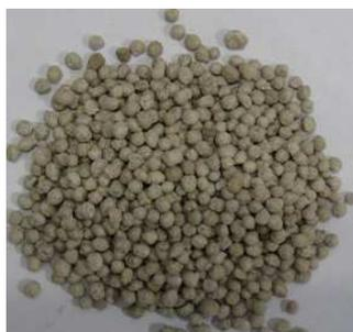
**Figure IV-3 : Billes de  $\beta$ -naphtol avec un diamètre entre 2.0 et 2.83 mm, produites par la méthode de "prilling fusion".**
