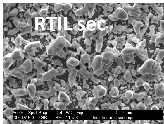
Figure 59 : Image MEB d'un dépôt réalisé sur acier inox dans le BEPipNTf 2 + InCl 3 .4H 2 O [In(III)] = 0,13 M, T = 60°C, E dépôt = E pic , (Q = -3,93 C), t dépôt = 1h.
