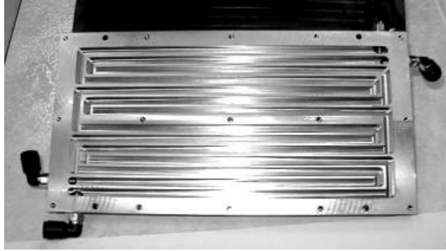
Figure IV-5 :  changeur   double courant invers  de la soci t  ACOME.
