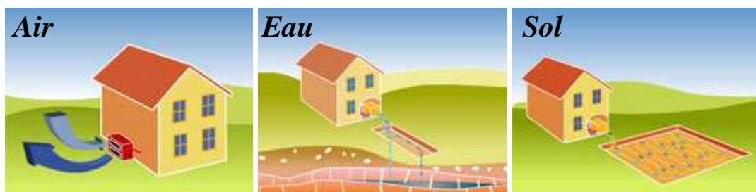
Figure II-1: Le côté source d'une pompe à chaleur
