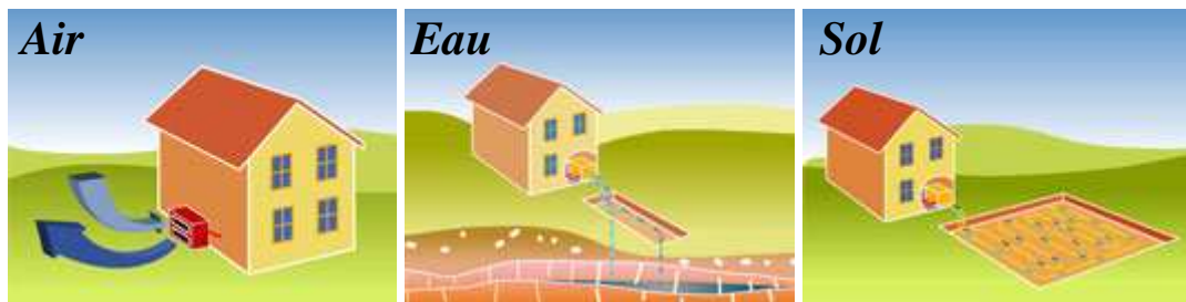
Figure II-1: Le côté source d'une pompe à chaleur
