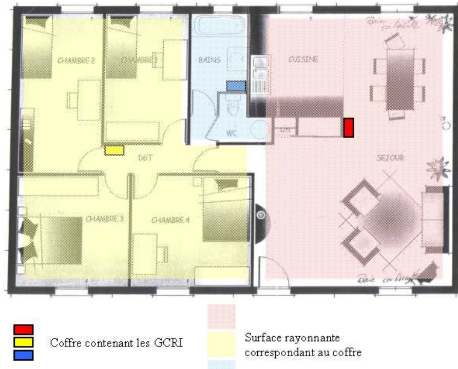
Figure VI-4 : Schéma de la configuration partiellement décentralisée du GCRI
