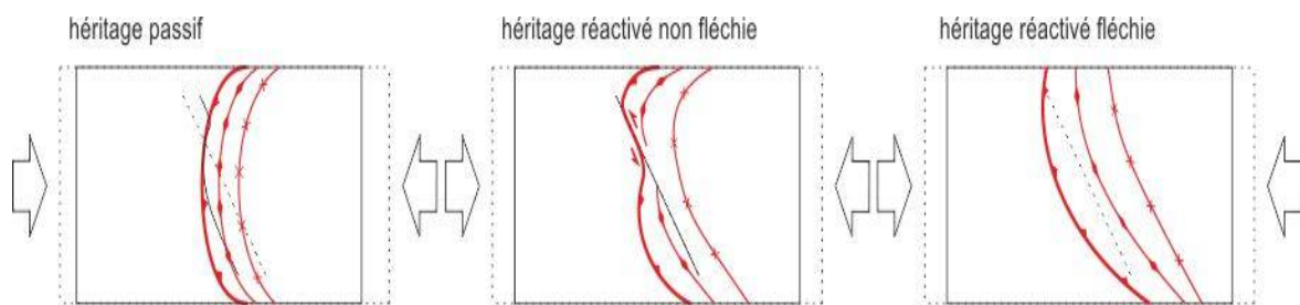
Figure V-12 : Schémas en plan synthétisant les principaux comportements d'une faille normale héritée reprise dans un contexte en compression.
