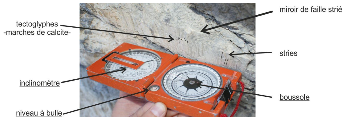
Figure II-18: Mesure de l'azimut d'un plan de faille striée avec une boussole Chaix 1002.
