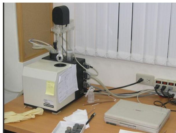
Figure II-15: Kappabridge KLY-3 (Agico) et exemple d'un spécimen. Les axes Ax1-2-3 définissent le référentiel du spécimen (x, y, z).
