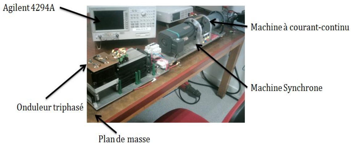
Figure.11 Identification de l'onduleur simple
