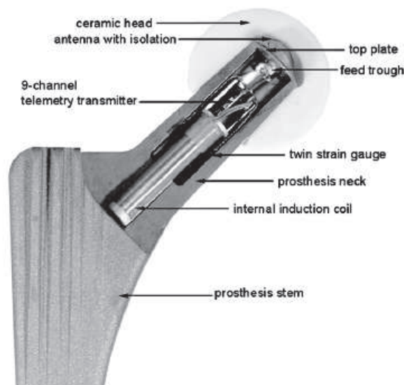
Figure 1.13 Prothèse instrumentée pour mesurer forces et moments dans une PTH (Damm et al., 2010)
