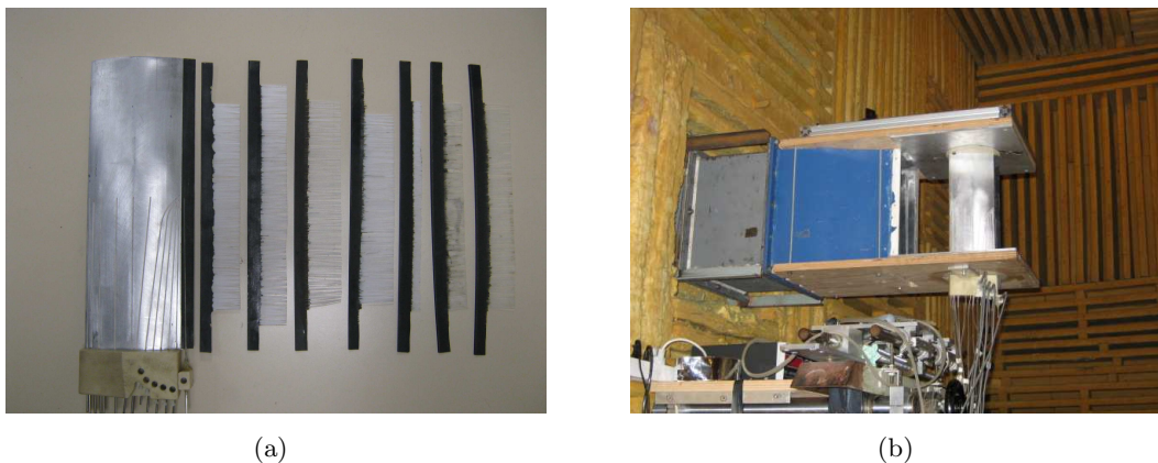
FIGURE 3.4 – Photo du profil utilisé muni du bord de fuite non traité de référence et les sept brosses adaptables (a) et du profil installé dans la soufflerie de la petite chambre sourde (b)
