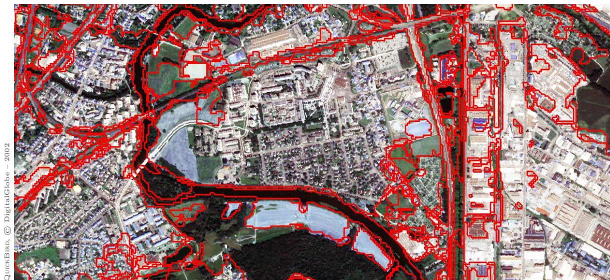
FIGURE 9.1 – Extrait d’une segmentation (dont les frontières des segments sont délimitées en rouge) réalisée sur une image MRS (9,6 m), projetée sur une image HRS (2,4 m). On peut observer que sur cette image HRS, les frontières des segments apparaissent comme crênelés.
