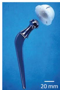
(a) Prothèse de hanche de Charnley (Delaunay, 1999) : “ Low Friction Arthroplasty ”, 1960
